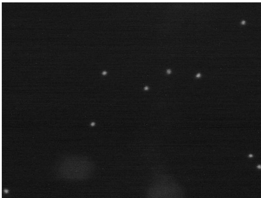
Obr. 21 – Měření průměru nanočástic v konjugátu Au10s + streptavidin ve FESEM.
