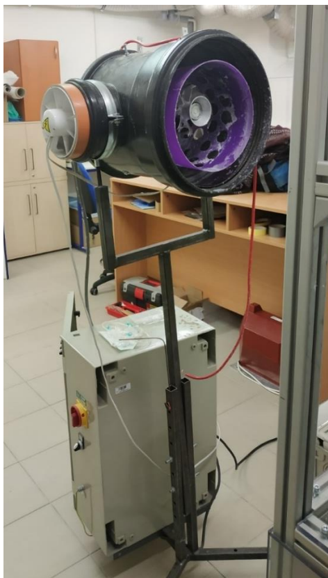
Obrázek 21 - Výchozí odstředivé zařízení s axiálním výstupem
