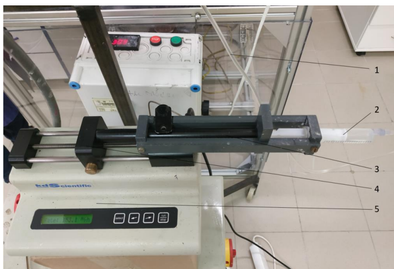
Obrázek 28 - Lineární pumpa s izolačním představcem, (1) výtlačná hadička, (2) injekční stříkačka, (3) izolační představec, (4) tlačný blok, (5) lineární pumpa
