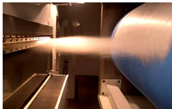
Obrázek 4 - Výroba nanovláken pomocí technologie melt blowing [3]
