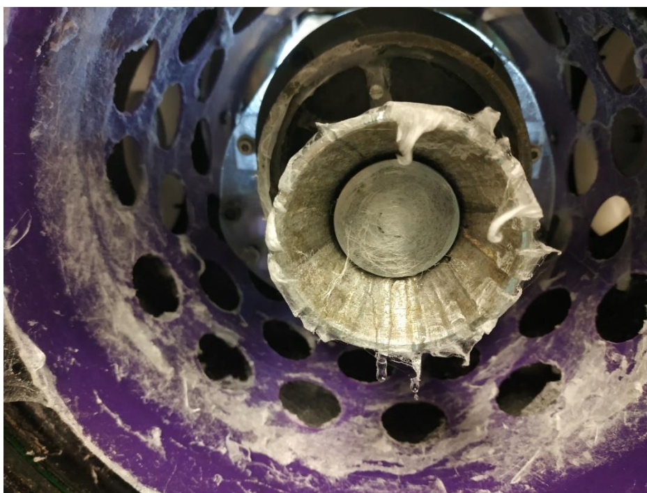
Obrázek 40 – Radiální cesty polymerního roztoku a nánosy na zvláknovací hlavě
