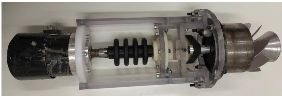
Obrázek 27 - Jednotka upravená pro elektroodstředivé zvlákňování
