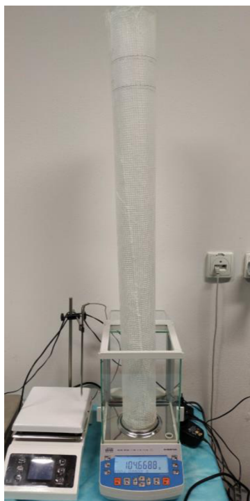
Obrázek 46 - Vážení nanosené nanovlákně vrstvy včetně perlínky
