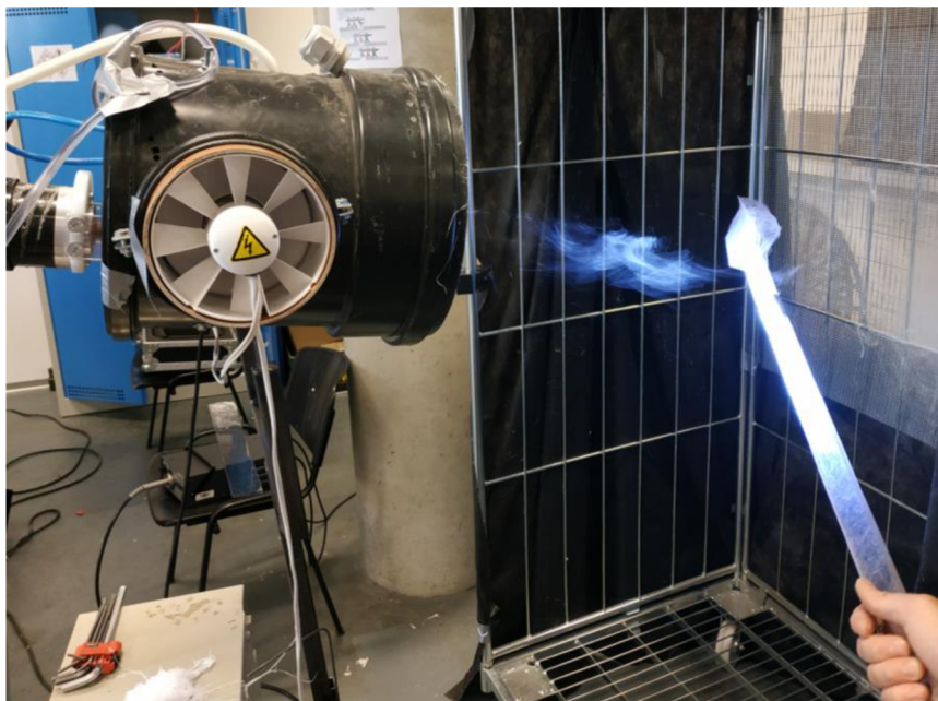
Obrázek 43 – Sběr vzorků pro rastrovací elektronový mikroskop
