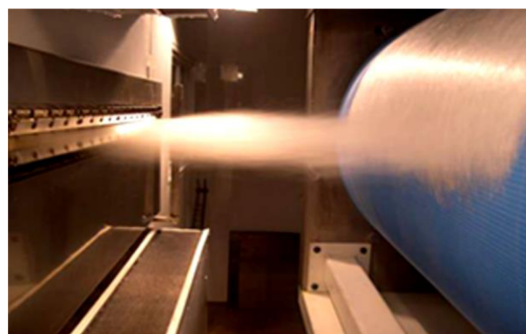
Obrázek 4 - Výroba nanovláken pomocí technologie melt blowing [3]
