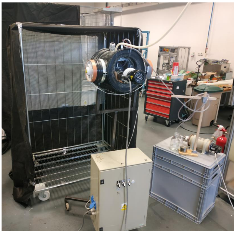
Obrázek 38 - Testovací aparatura. Zleva - zvláknovací box, upravené elektroodstředivé zařízení, čerpací jednotka
