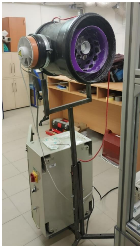
Obrázek 21 - Výchozí odstředivé zařízení s axiálním výstupem
