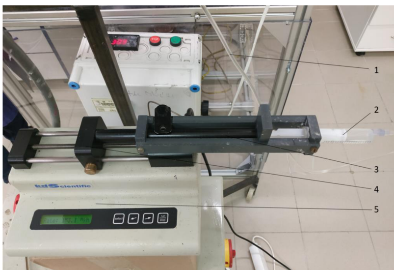
Obrázek 28 - Lineární pumpe s izolačním představcem, (1) výtlačná hadička, (2) injekční stříkačka, (3) izolační představec, (4) tlačný blok, (5) lineární pumpe
