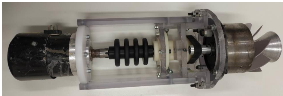
Obrázek 27 - Jednotka upravená pro elektroodstředivé zvlákňování
