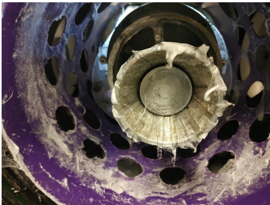
Obrázek 40 – Radiální cesty polymerního roztoku a nánosy na zvláknovací hlavě
