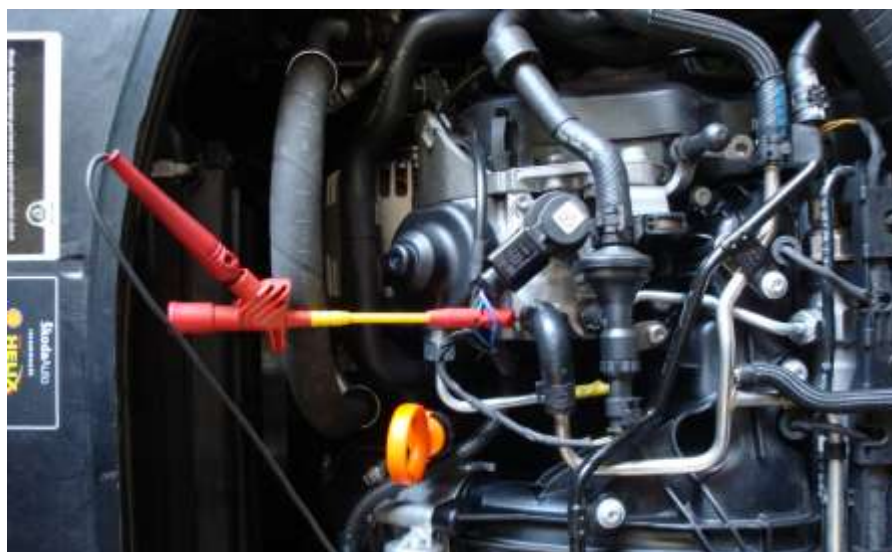
Foto 17 Zapojení dávkovacího ventilu na čerpadle. Detail.
