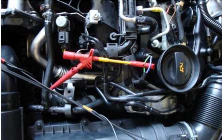
Foto 20 Zapojení proudových kleští na regulační ventil na railu.
