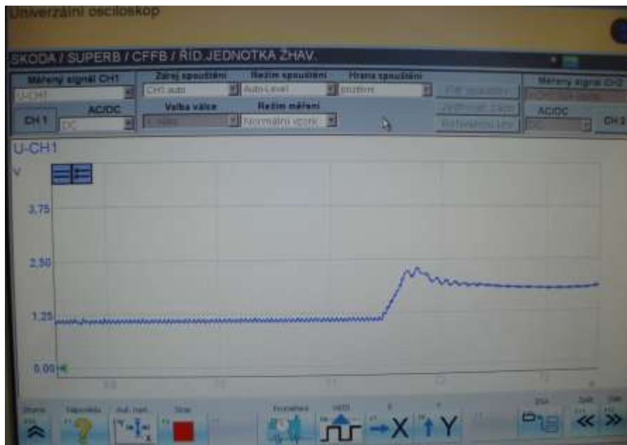
Foto 40 Napětí na snímači tlaku v railu: akcelerace (při stojícím vozidle).
