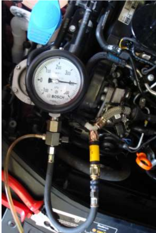
Foto 40 Příklad na měření tlaku -V.A.G. 1318-. Nastartovaný motor. Volnoběh.
