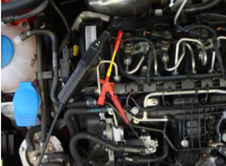
Foto 11 Připojení osciloskopu a proudových kleští na kabel vstříkovací jednotky.
