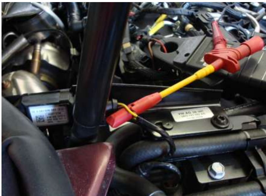
Foto 14 Zapojení proudový kleští na kabel snímače filtru pevných částic
