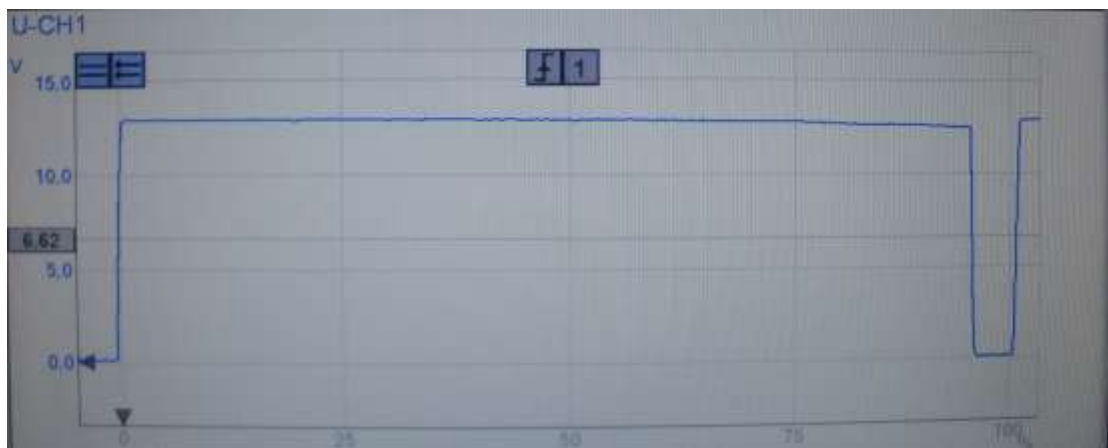
Graf 6 Průběh napětí při volnoběhu.
