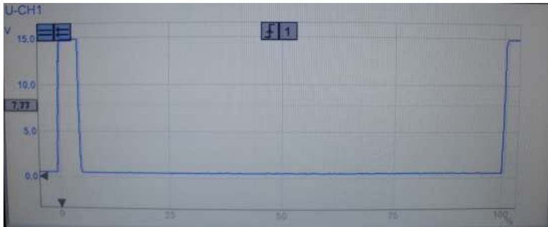
Graf 5 Průběh napětí. Zapnuté zapalování. Motor vypnutý.
