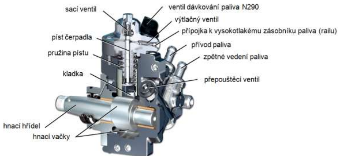
Obr. 19 Vysokotlaké palivové čerpadlo
