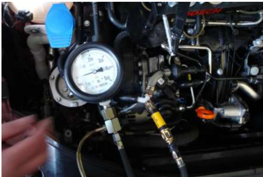
Foto 9 Přístroj na měření tlaku -V.A.G. 1318-. Vypnuté zapalování.
