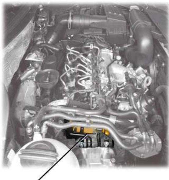
Obr. 15 Přídavné palivové čerpadlo V393 (umístění v motoru)
