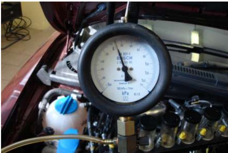
Foto 38 Přístroj na měření tlaku -V.A.G 1318-. Měření při: 2500 ot/min.
