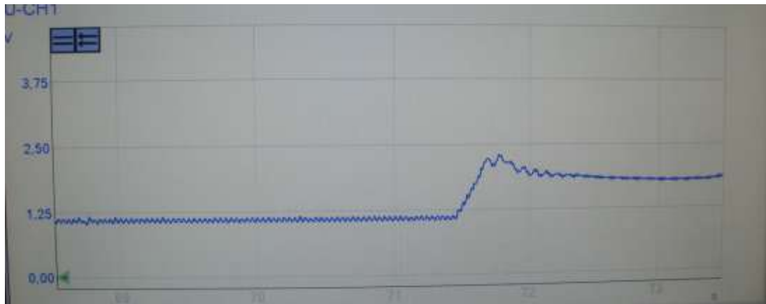
Graf 10 Napětí na snímači tlaku v Railu: Akcelerace (při stojícím vozidle).
