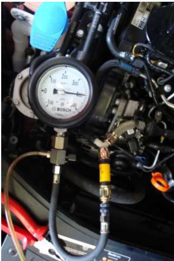
Foto 10 Příklad na měření tlaku -V.A.G. 1318-. Nejvyšší hodnota tlaku palivového systému.
