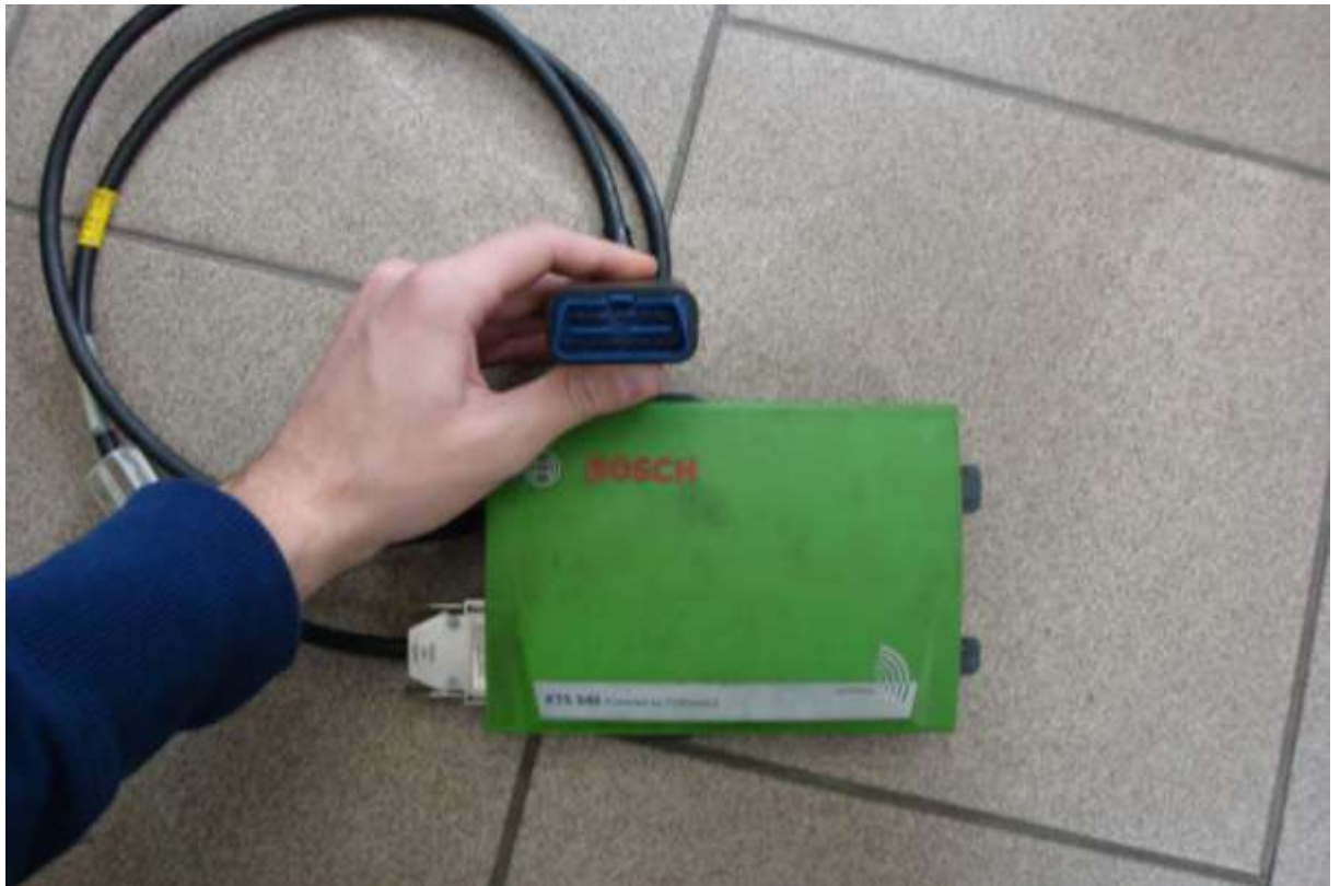
Foto 2 Připojení KTS 540 (ESI tronic)
