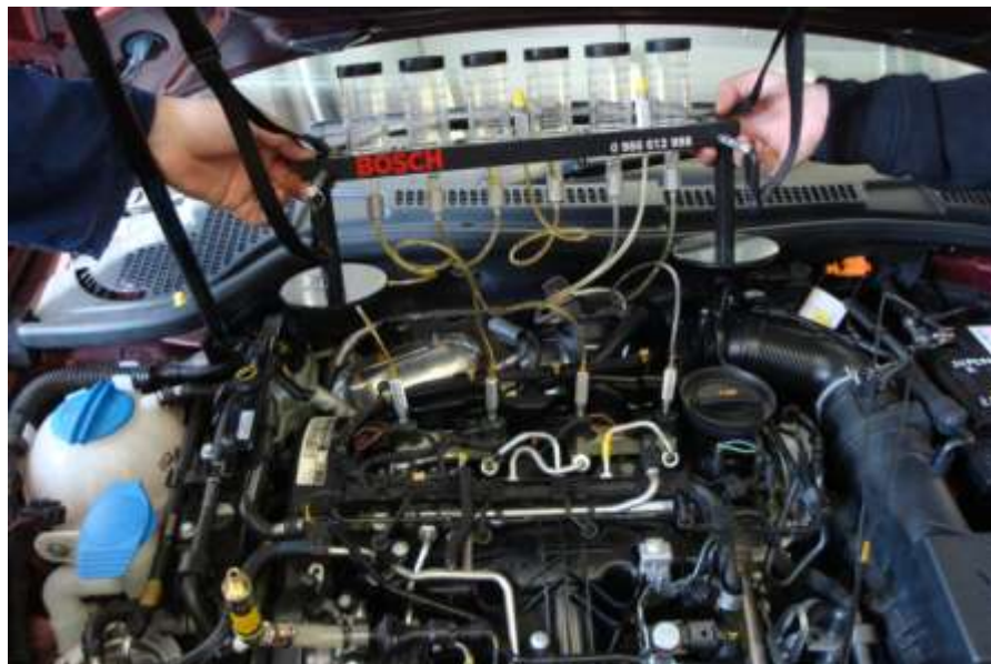
Foto 27 Měření přepadových množství z jednotlivých injektorů.
