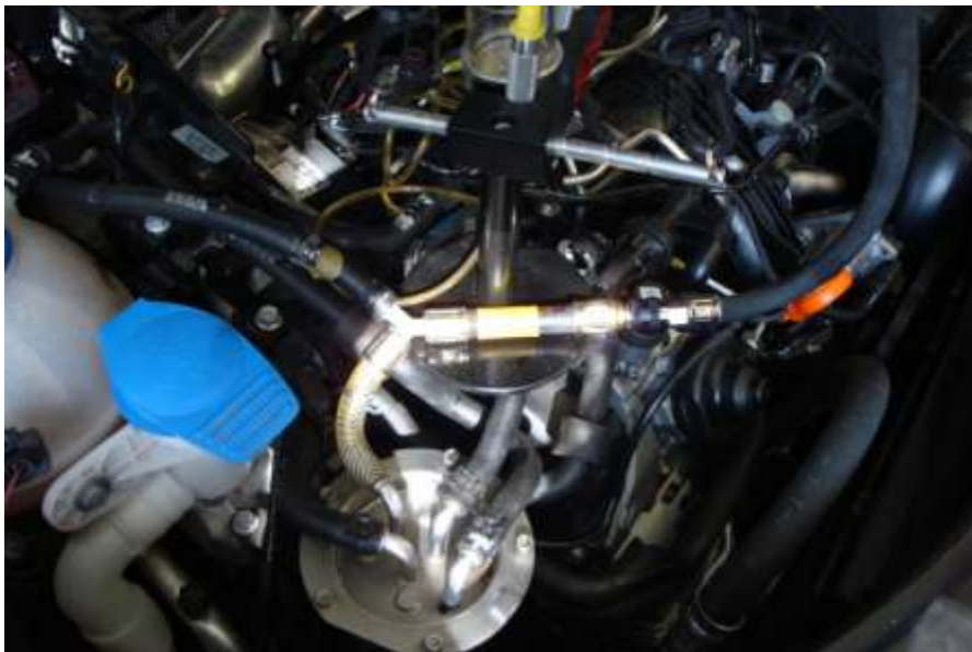
Foto 6 Připojení přístroje na měření tlaku -V.A.G 1318-
