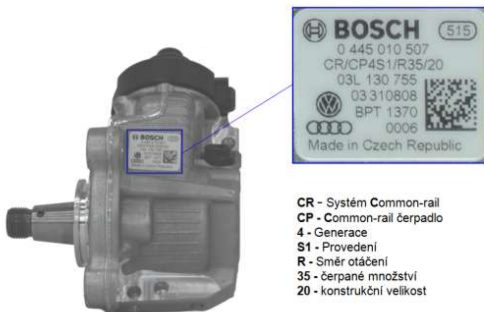
Obr. 20 Značení vysokotlakého palivového čerpadla
