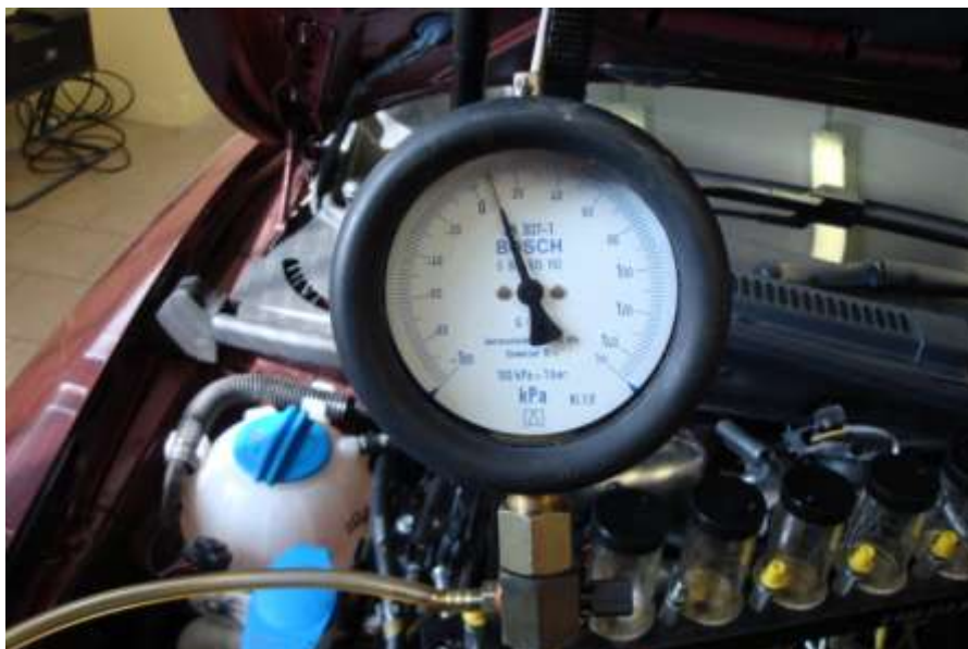
Foto 8 Příklad na měření tlaku -V.A.G 1318-. Měření při: 2500 ot/min.
