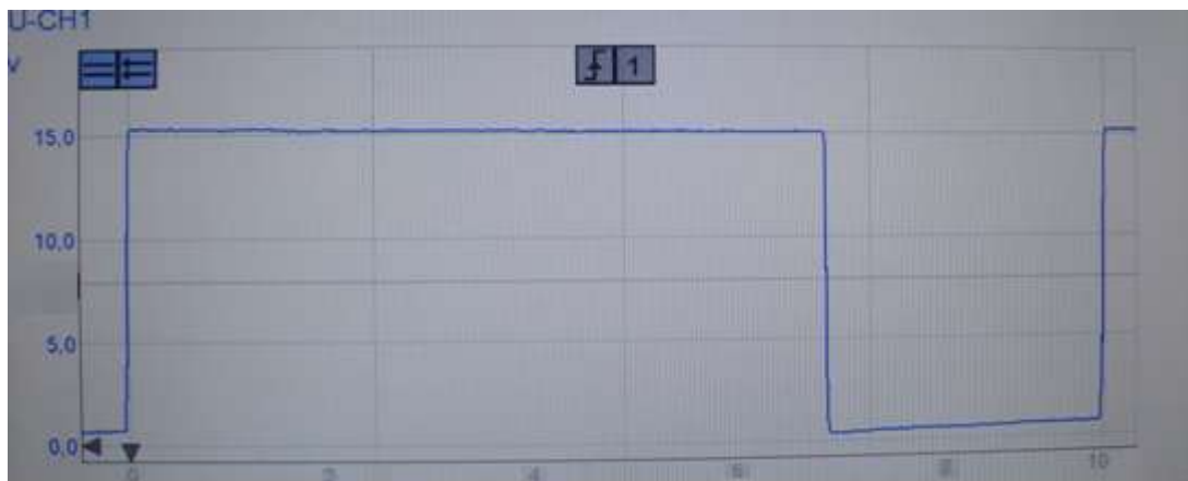
Foto 22 Průběh napětí na regulačním ventilu na Railu. Otáčky 2500 ot/min.
