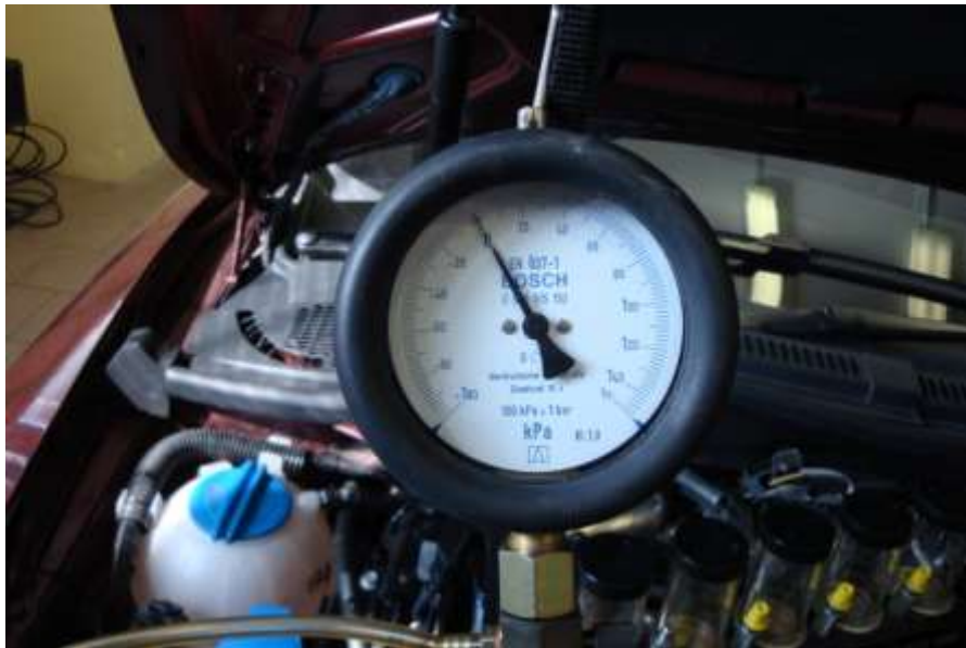
Foto 7 Příklad na měření tlaku -V.A.G 1318-. Vypnutý motor.
