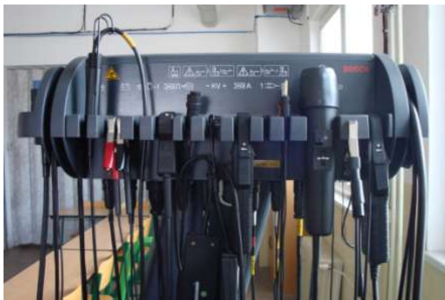
Foto 4 Diagnostický přístroj FSA 740. Měřicí zařízení.
