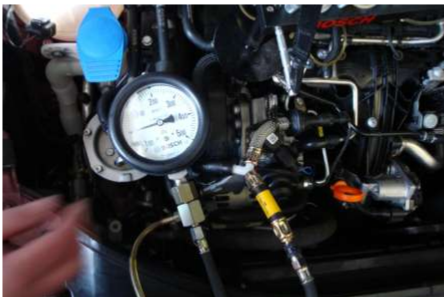
Foto 39 Přístroj na měření tlaku -V.A.G. 1318-. Vypnuté zapalování.
