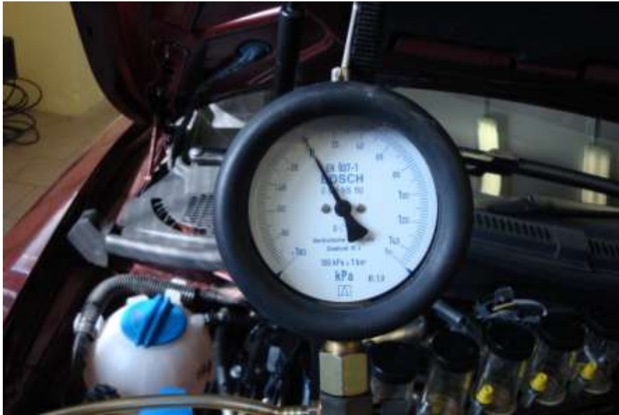
Foto 37 Přístroj na měření tlaku - V.A.G 1318-. Vypnutý motor.
