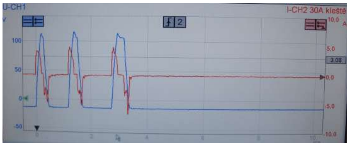
Graf 1 Průběh napětí a proudu na vstřikovací jednotce. volnoběh
