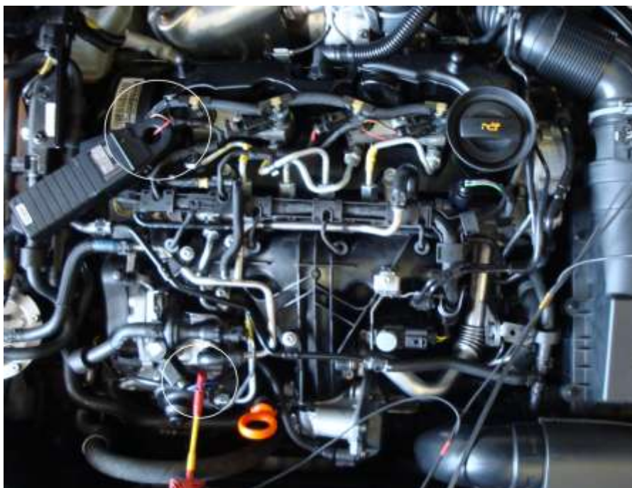
Foto 16 Zapojení dávkovacího ventilu na čerpadle.
