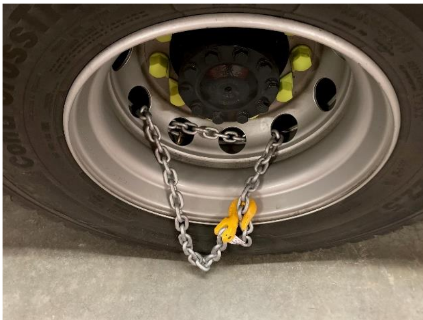
Obrázek 46 - Využití zkracovacích řetězů. Zdroj: vlastní zpracování.
