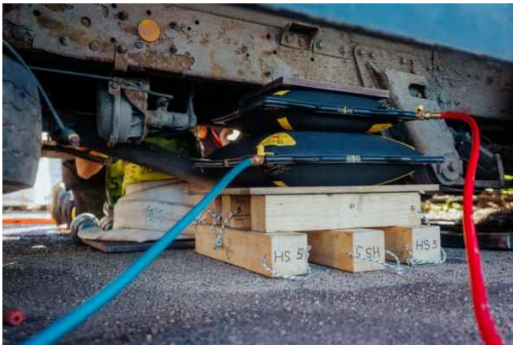
Obrázek 36 - Stabilizace podvozku pomocí vaků. Zdroj: vlastní zpracování.
