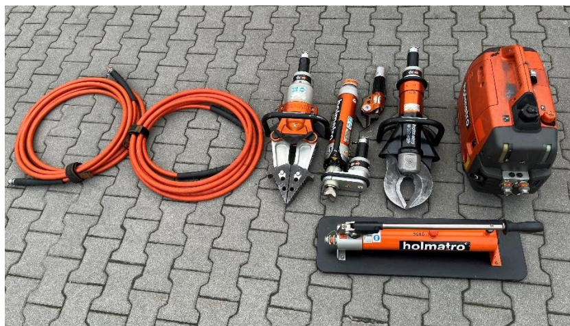
Obrázek 10 - Ukázka vybavení hydraulického vyprošťovacího zařízení. Zdroj: vlastní zpracování.
