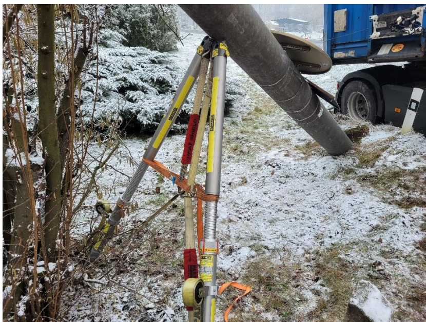
Obrázek 3 - Ukázka použití stabilizačních tyčí. Zdroj: vlastní zpracování.
