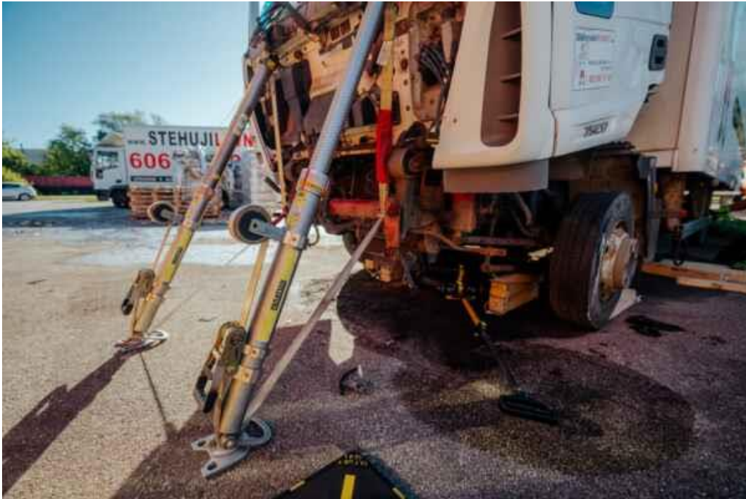
Obrázek 35 - Stabilizace kabiny pomocí rozpěrných tyčí. Zdroj: vlastní zpracování.
