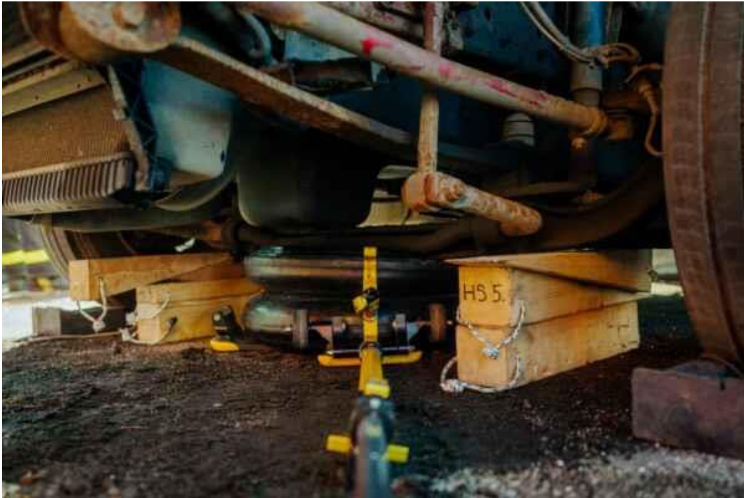
Obrázek 37 - Stabilizace pomocí vaku „Sněhulák“ Zdroj: vlastní zpracování.
