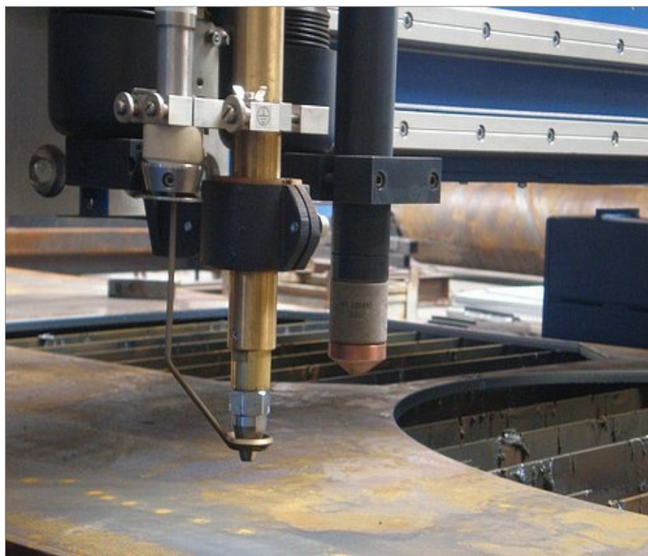
Obrázek 21 - Kapacitní snímač pro řezání plamenem. [14]
