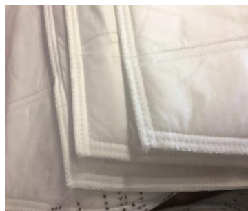
Obr. 3.11 Šitý filtr (vlevo), Svařovaný ultrazvukem (vpravo) [3]
