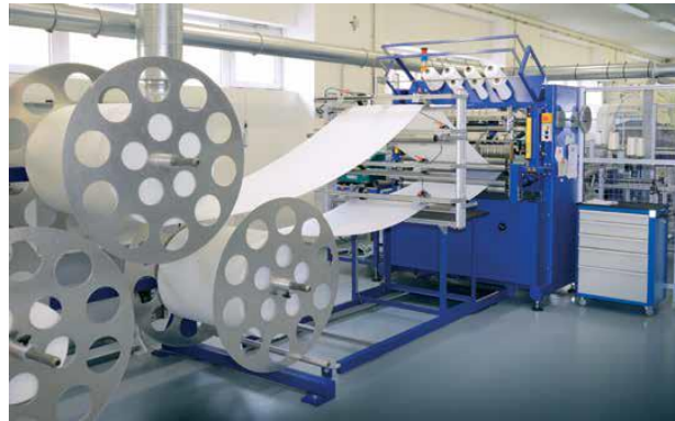
Obr. 3.10 Ultrazvuková svařovací linka (vlevo), automatická šicí linka (vpravo) [34], [35]
