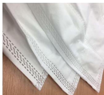
Obr. 3.11 Šitý filtr (vlevo), Svařovaný ultrazvukem (vpravo) [3]
