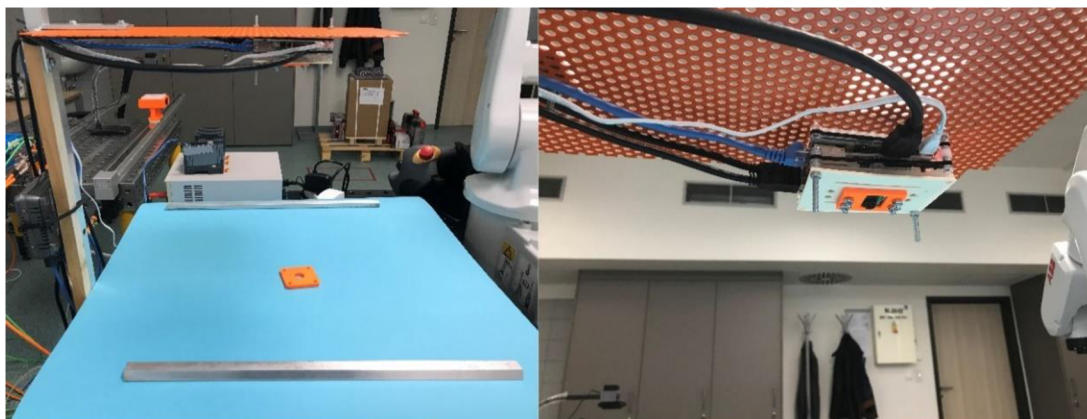
Obr. 47: Vlevo realizace stojanu, vpravo detail uchycení RPi
