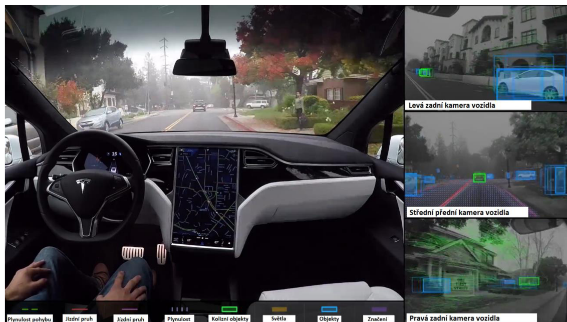
Obr. 5: Využití počítačového vidění u automobilu Tesla – upraveno [10]
