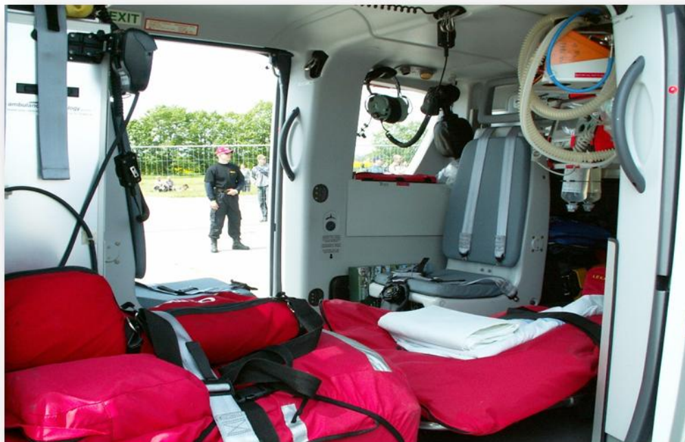
Obrázek 4: Vnitřní vybavení vrtulníku EC-135 T2 pro leteckou záchranou službu
