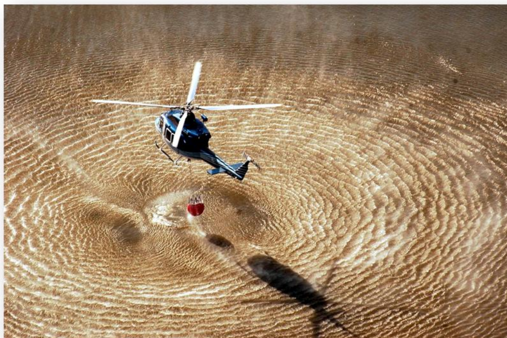
Obrázek 7: Nabírání vody do bambi vaku
