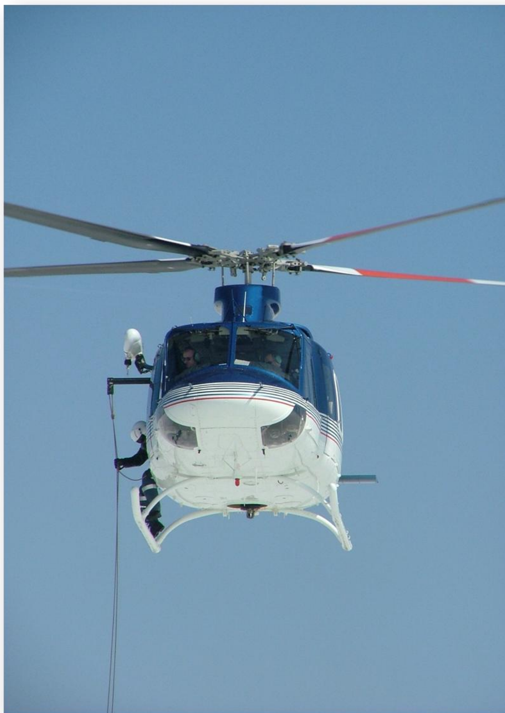
Obrázek 9: Vrtulník Bell-412 se speciálním jeřábem s podvěsem
