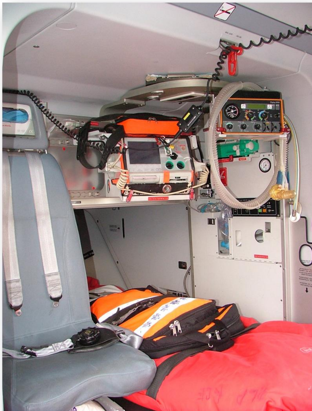
Obrázek 3: Vnitřní vybavení vrtulníku EC-135 T2 pro leteckou záchrannou službu
