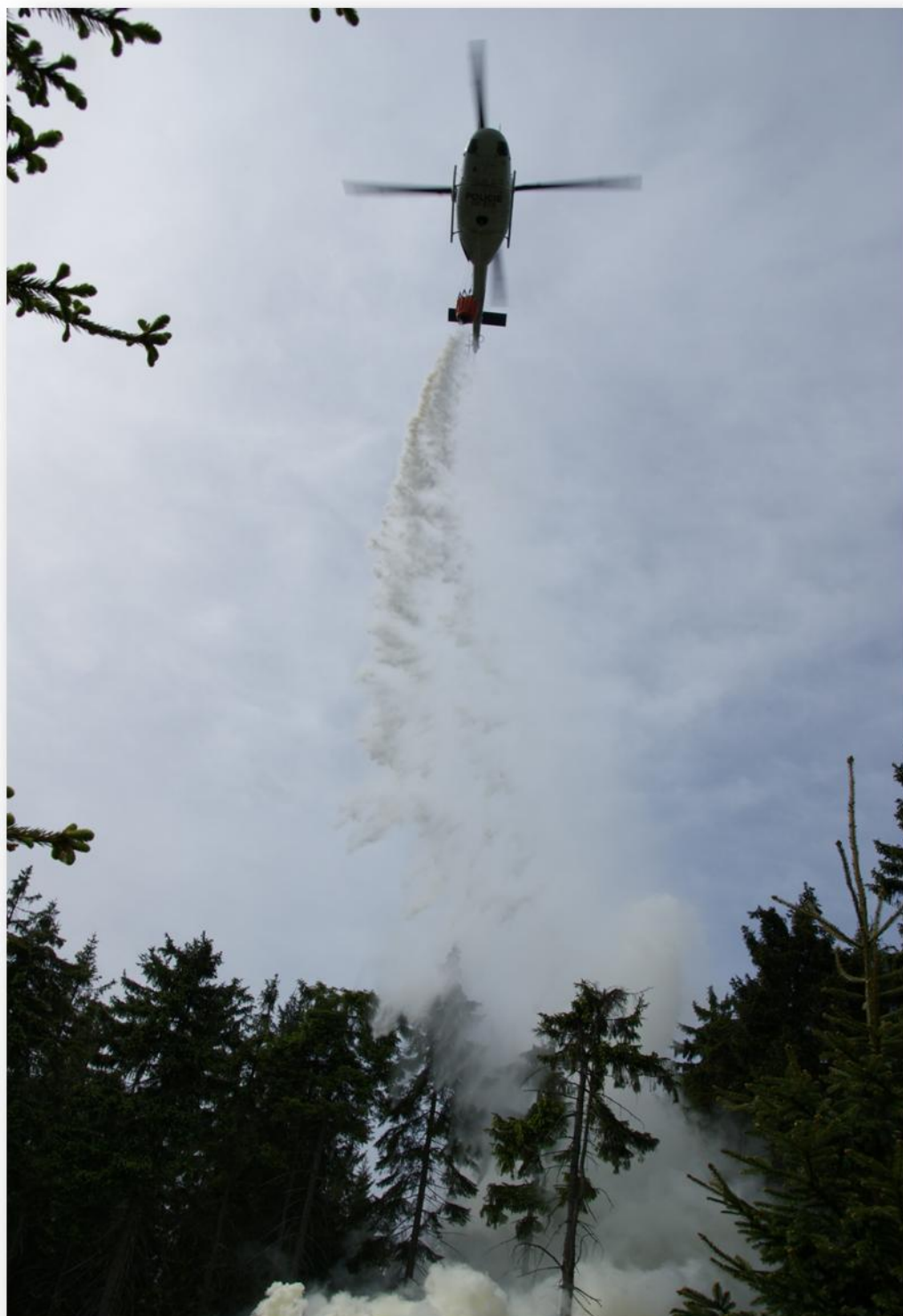
Obrázek 8: Hašení lesního požáru pomocí bambi vaku
