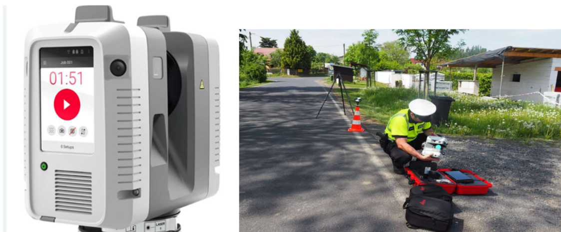
Obrázek 31: Příklad použití přístroje Leica RTC60 a jeho využití v policejní praxi
