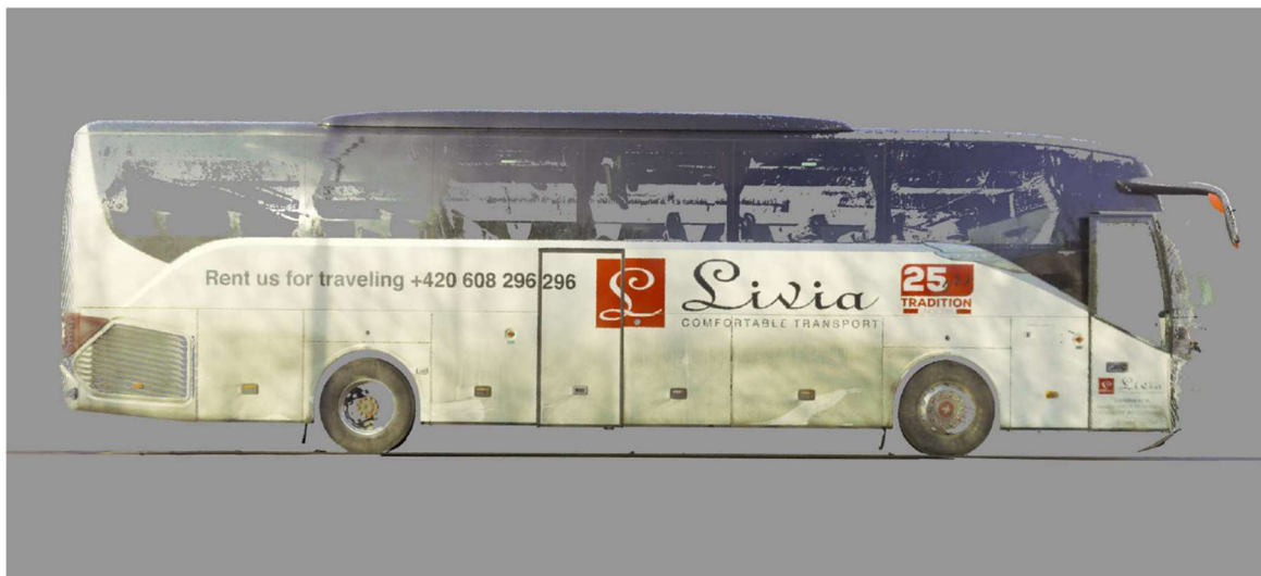
Obrázek 37: Výstupní boční měřičský snímek, výstup laserového skenování
