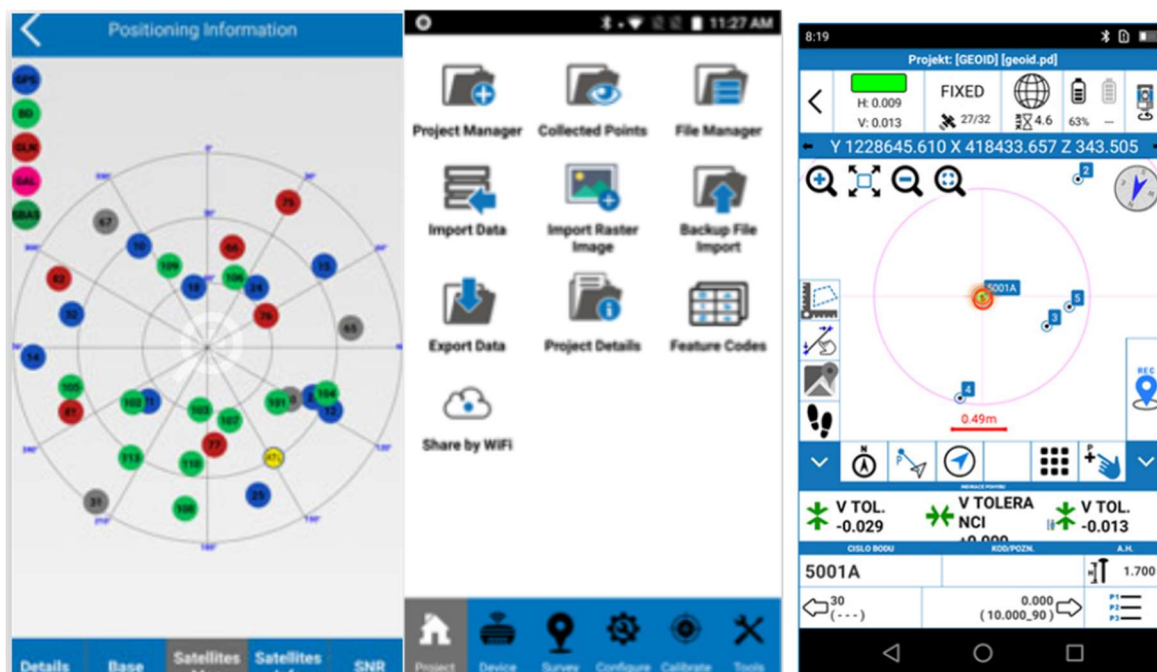
Obrázek 12: Ukázka aplikace Cube-a GNSS stanice StonexS900, příjem satelitních signálů, nastavení úlohy a zápis zaměřeného bodu.
