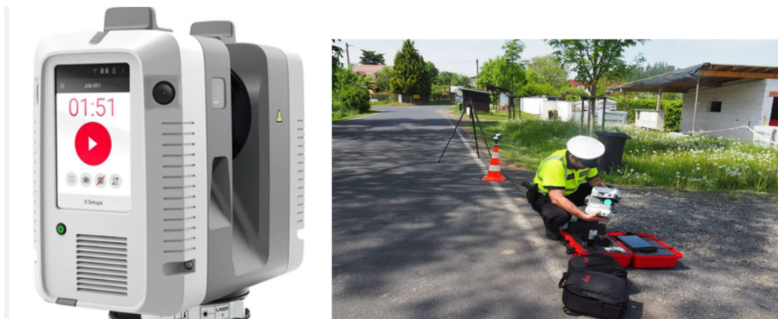
Obrázek 31: Přístroj Leica RTC60 a jeho využití v policejní praxi
