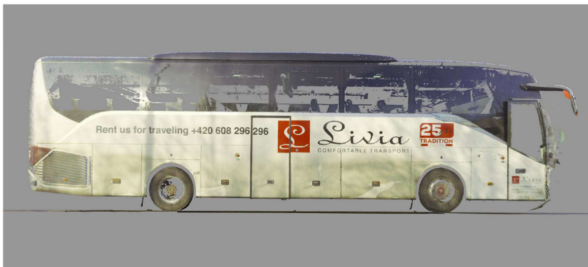
Obrázek 37: Výstupní boční měřičský snímek, výstup laserového skenování
