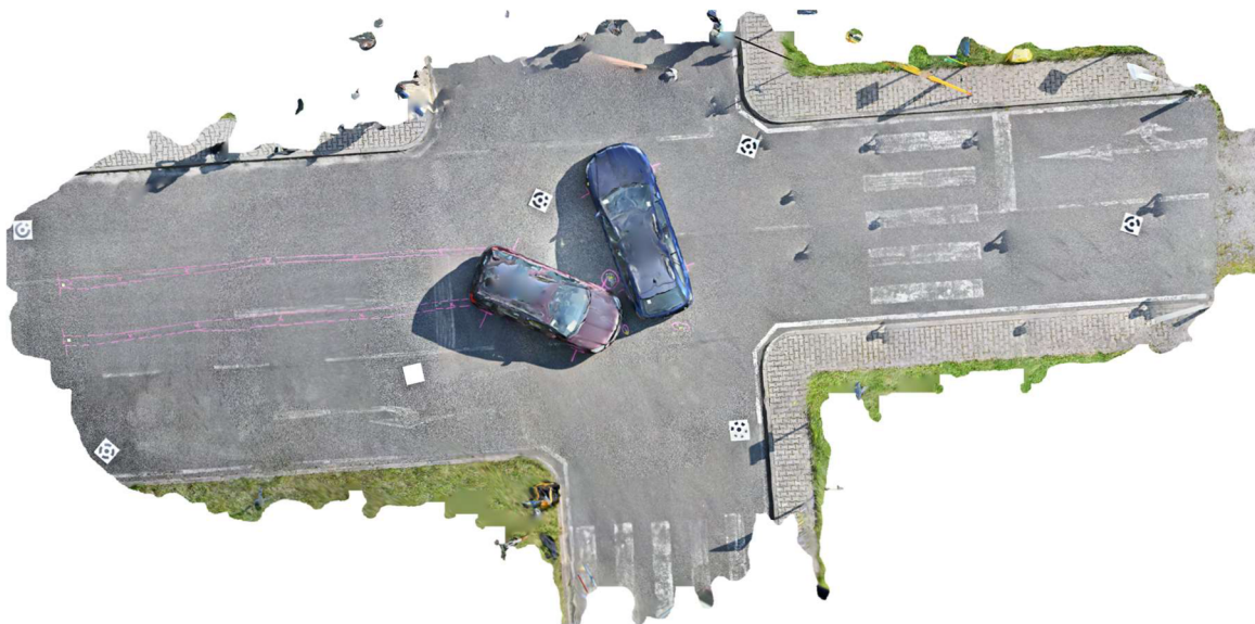
Obrázek 16: Výstupní měřičský ortosnímek získaný z pozemní vícesnímkové fotogrammetrie
