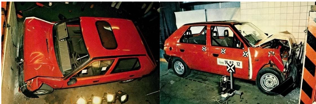
Obr. 20 Zkouška pasivní bezpečnosti nárazem na tuhou překážku [9]
