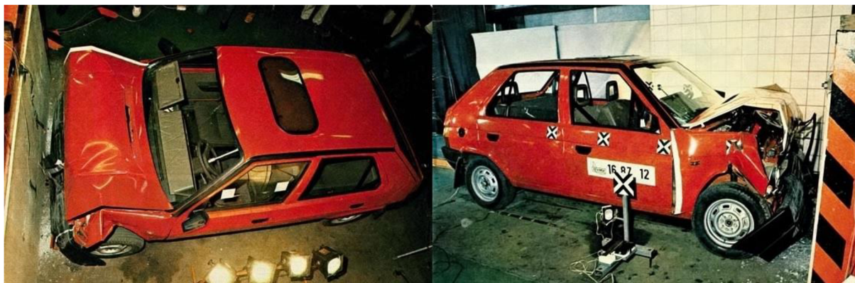
Obr. 20 Zkouška pasivní bezpečnosti nárazem na tuhou překážku [9]
