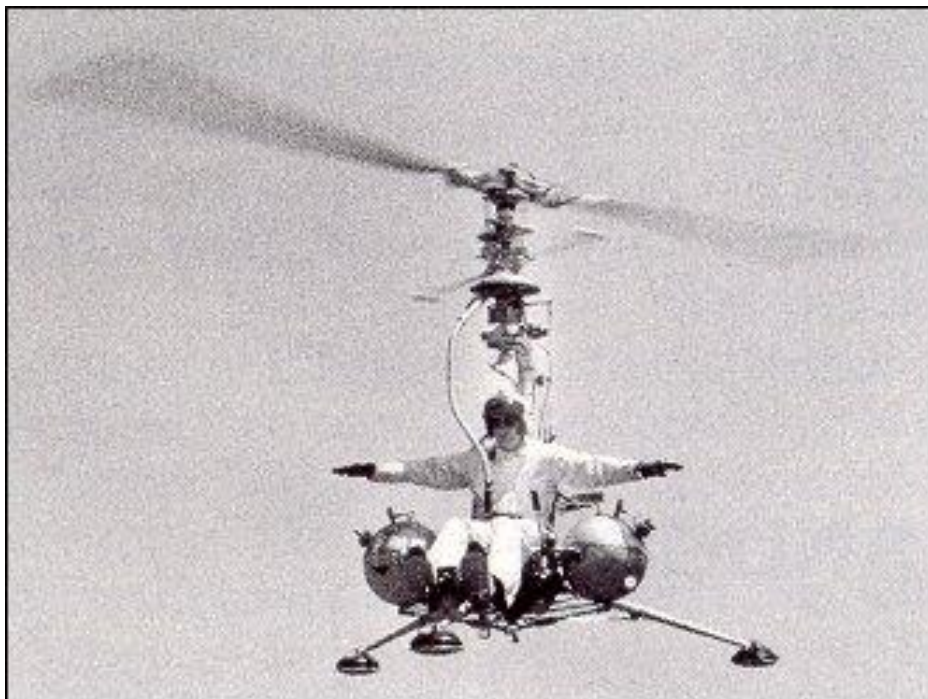
Obr. 32 Kellett KH-15 „Stable Mable“ s raketovými motormi na konci listov nosného rotoru
