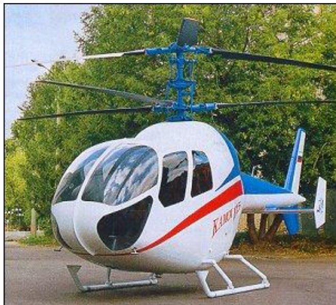
Obr. 14 Ka-115 "Moskvichka" s koaxiálnym usporiadaním rotorov
