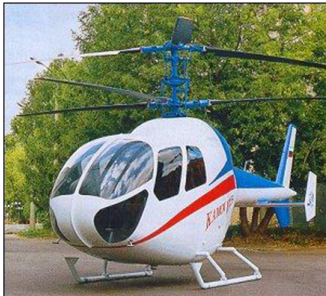
Obr. 14 Ka-115 "Moskvichka" s koaxiálnym usporiadaním rotorov
