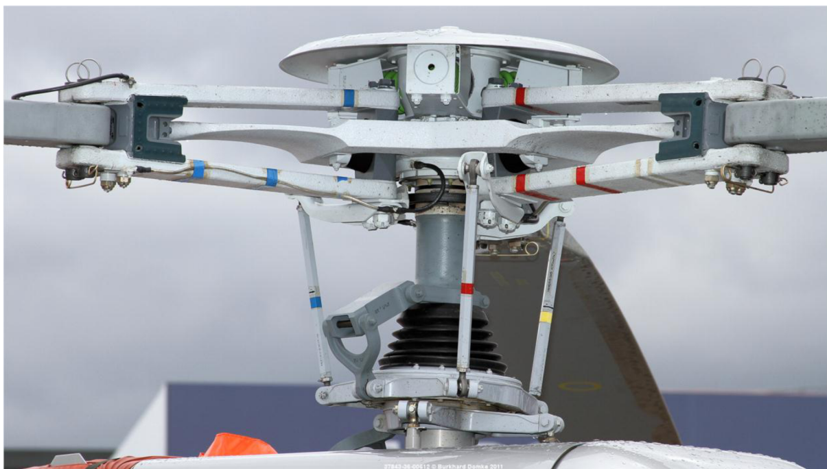
Obr. 30 Použitie elastomerného ložiska na stroji Eurocopter AS355
