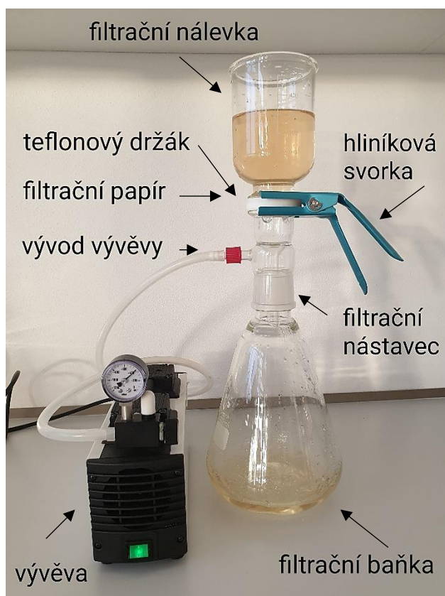
Obrázek 18 - vakuová filtrační aparatura
