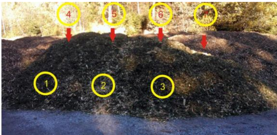
Obrázek 3 Schéma odběru reprezentativního vzorku (zdroj, ŠTOREK, et al. 2019)
