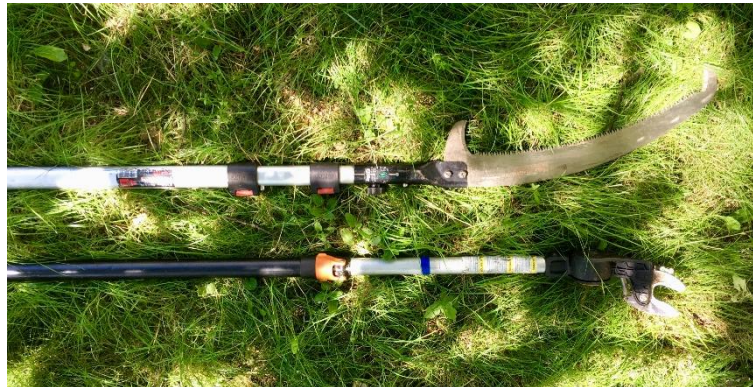
Obr.4 Teleskopické nářadí pro řez podchozí a podjezdové výšky.
