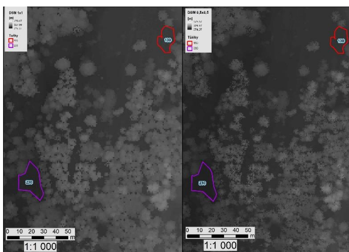
Obrázek 32: Porovnání rozlišení DSM (vlevo 1x1m, vpravo 0,5x0,5m) pro výřez tůňek 130 a 230.
