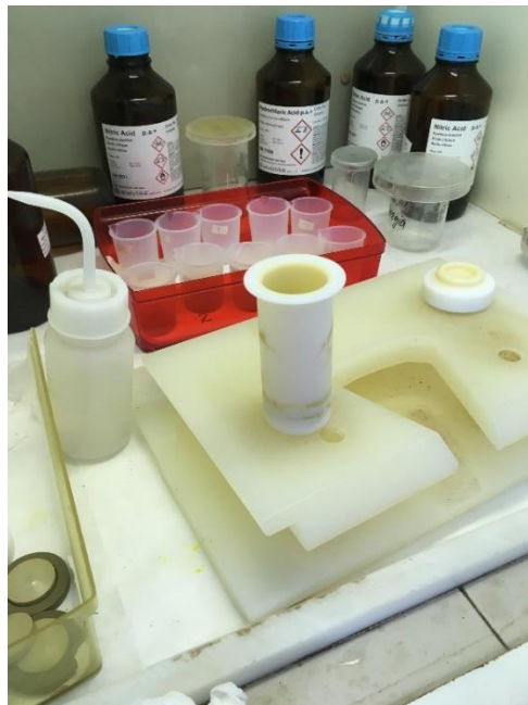
Obrázek 6 Teflonová nádoba pro stanovení pseudocelkového obsahu prvků ve vzorku
