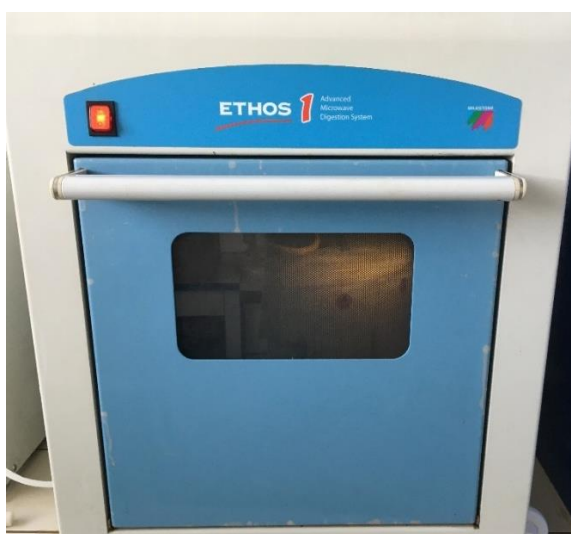
Obrázek 7 Zařízení Ethos 1 pro extrakci vzorků při stanovení pseudocelkového obsahu prvků
