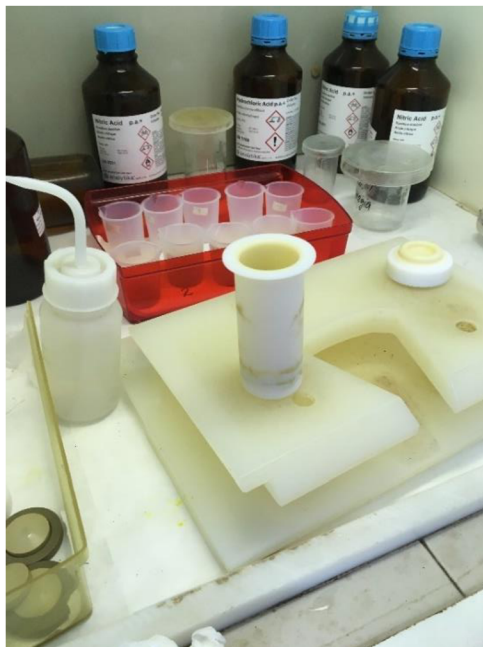
Obrázek 6 Teflonová nádoba pro stanovení pseudoocelkového obsahu prvků ve vzorku
