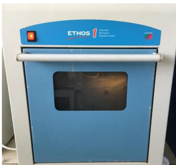
Obrázek 7 Zařízení Ethos 1 pro extrakci vzorků při stanovení pseudoocelkového obsahu prvků
