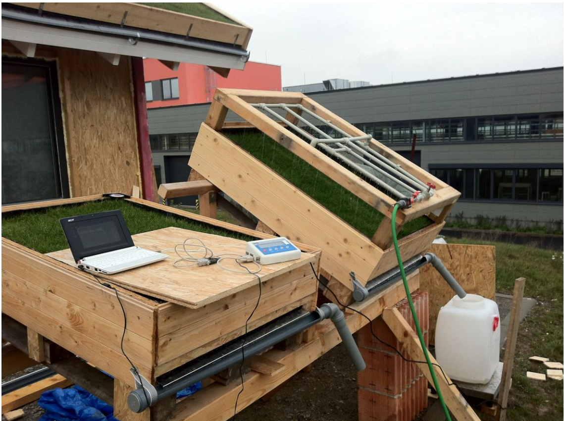
Obr. 5.10 – Průběžný záznam dat na přenosný počítač (autor, 23.11.2015).
