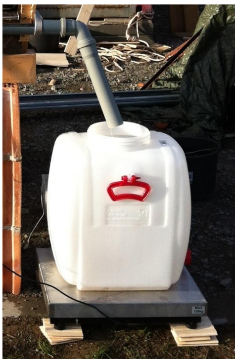
Obr. 5.6 - Sběrná nádoba o objemu 60 l, umístěna na váze (autor, 23.11.2015).
