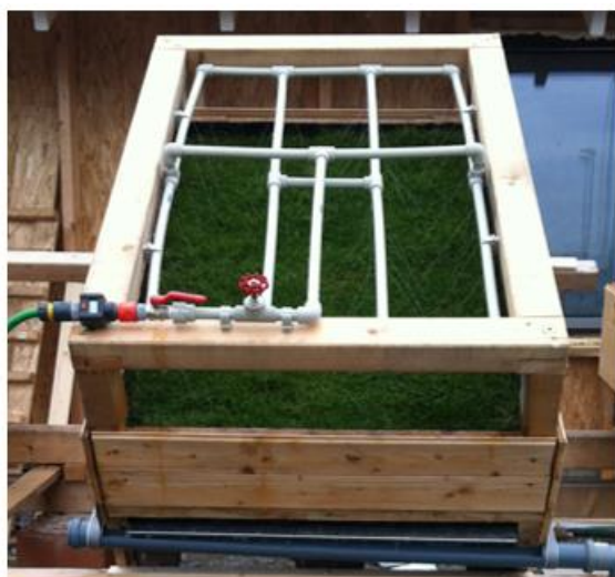
Obr. 5.4 - Zavlažovací systém testovaných modelů (autor, 26.11.2016).
