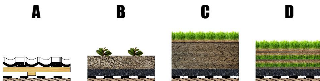
Obr. 5.1 – Skladby zkušebních střech s označením (autor).
