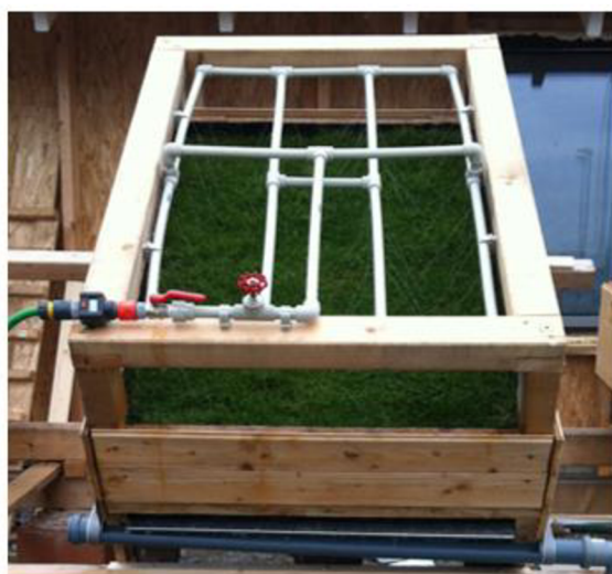
Obr. 5.4 - Zavlažovací systém testovaných modelů (autor, 26.11.2016).
