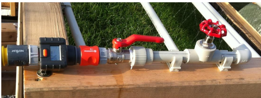
Obr. 5.5 – Zapojení měřicího a regulačního systému zavlažování (autor 26.11.2016).
