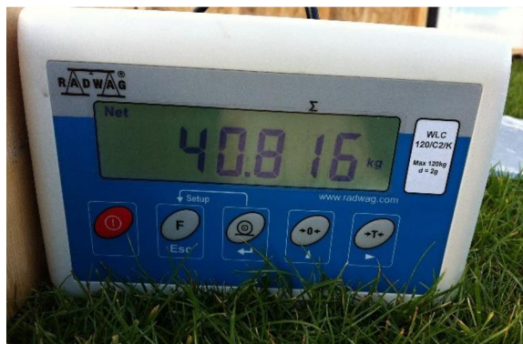
Obr. 5.7 - LCD displej vah RADWAG WLC 120/C2/K (autor, 23.11.2015).
