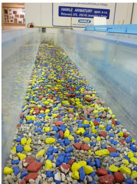
Obr. 6.1 Nestejnozrný materiál. Vlevo pohled na uložená zrna ve žlabu. Vpravo zobrazený kontrolní profil. Červená barva frakce 25–31,5; žlutá barva frakce 20–25; modrá barva frakce 16–20; frakce menší nabarveny nejsou
