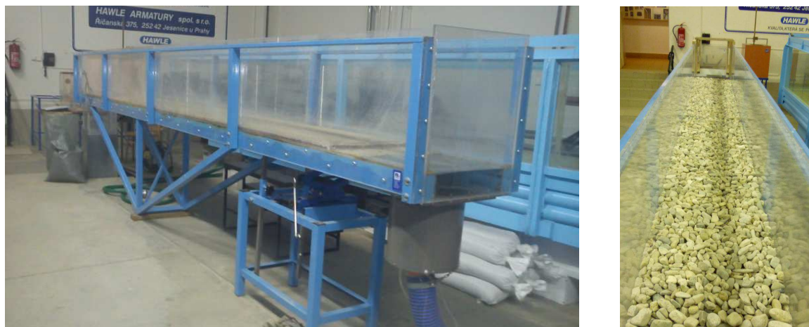
Obr. 4.1 Vlevo pohled na sklopný žlab, v popředí žlabu nátok s polohovacím zařízením žlabu, vpravo pohled do žlabu na urovnaný materiál
