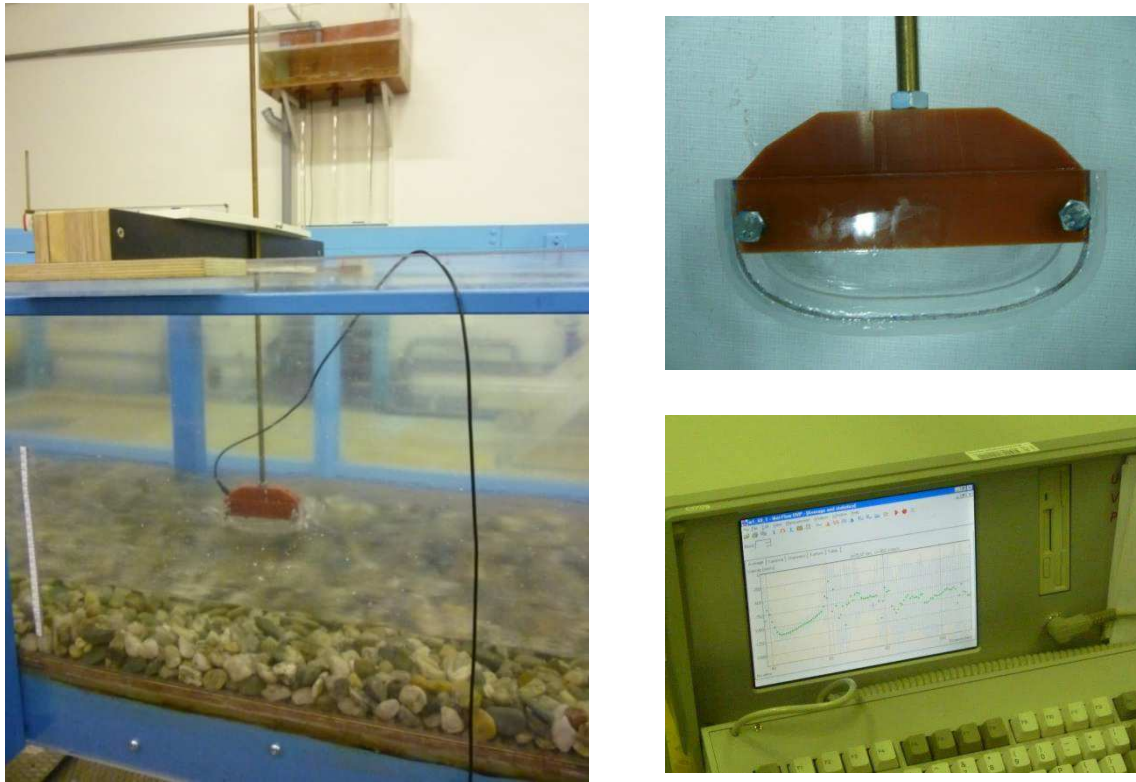
Obr. 5.1 Vlevo měření bodových rychlostí protiproudě natočenou sondou umístěnou v měřidle, vpravo detail měřidla a ukázka změřených bodových rychlostí po délce UV paprsku UVP Monitorem
