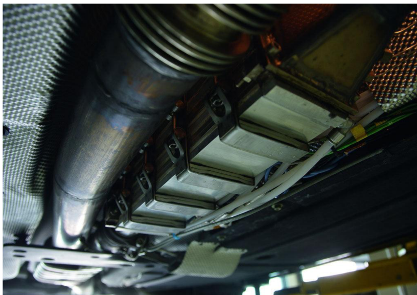
Obr. 9 – Využívání tepla výfuku pomocí TEG článků automobilkou BMW [15]
