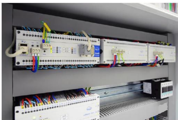
Obr. 5.8 Měřicí ústředna Delphin Technology [28]
