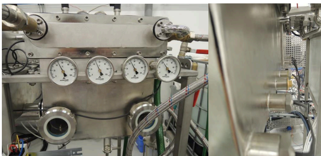
Obr. 5.3 Bimetalické (vlevo) a odporové teploměry (vpravo)
