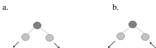
Obr. 2 Znárodnění valenčních vibrací molekul: a. symetrická, b. antisymetrická vibrace
