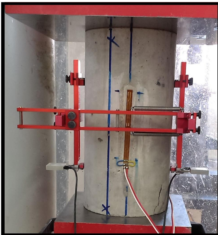
Obr. 18 Detail odporových a elektronických tenzometrů
