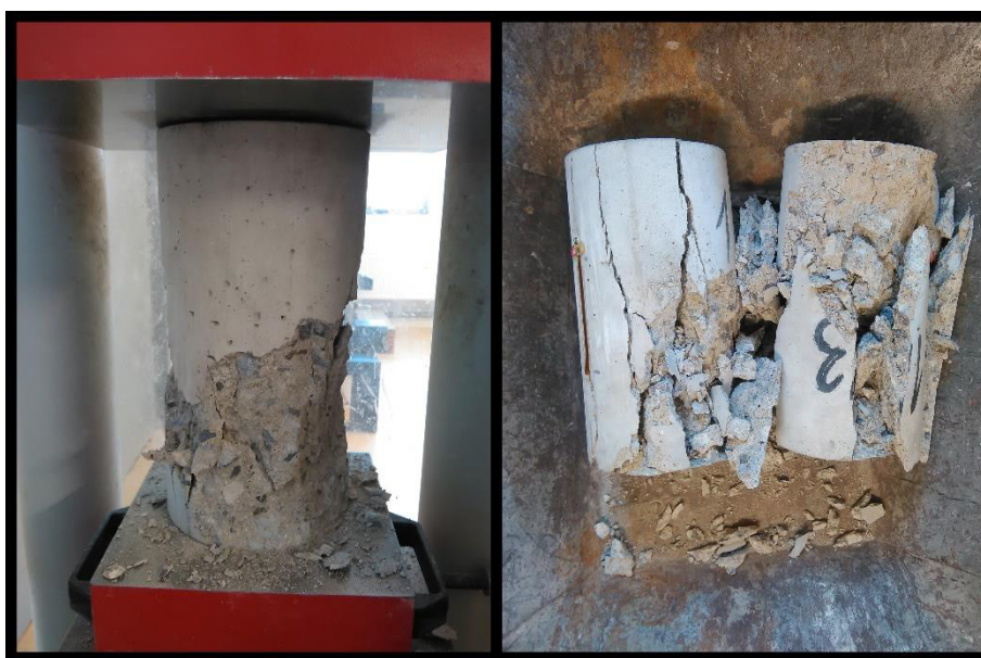
Obr. 16 Tělesa porušená po zkoušce pevnosti v tlaku
