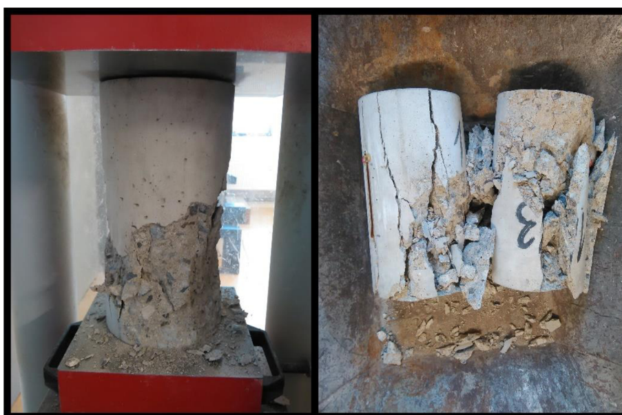
Obr. 16 Tělesa porušená po zkoušce pevnosti v tlaku
