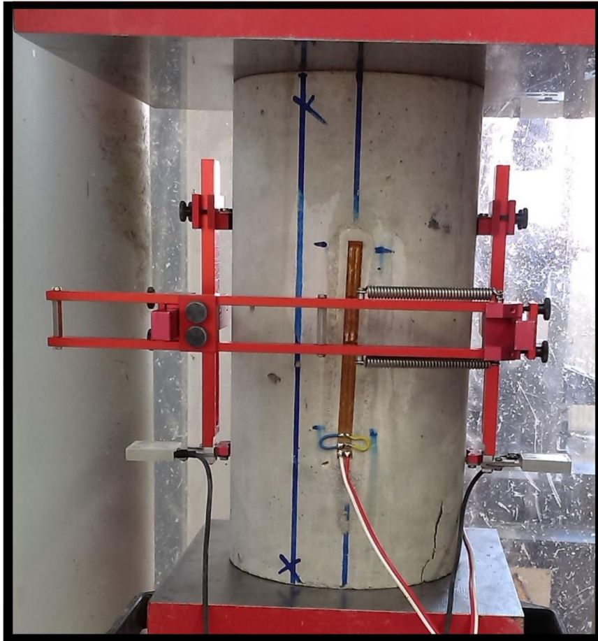
Obr. 18 Detail odporových a elektronických tenzometrů
