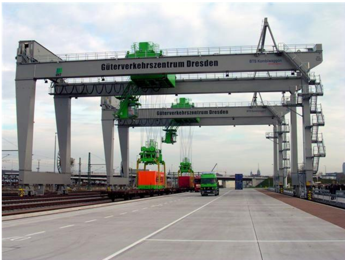
Obrázek. 3 - Horizontální překládka výměnné nástavby na překladišti v německých Drážďanech. [1]
