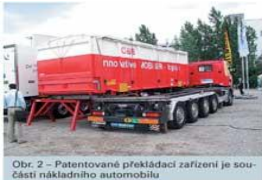
Obrázek 2 - Vizualizace systému překládky Mobiler. [30]
