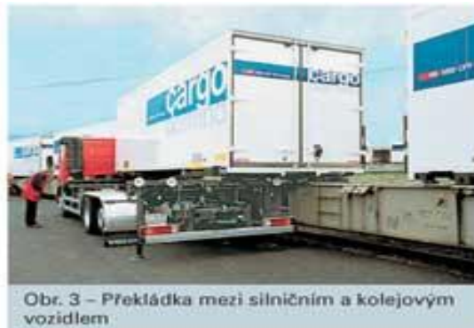
Obrázek 2 - Vizualizace systému překládky Mobiler. [30]
