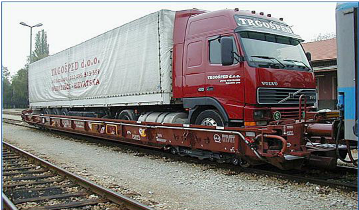
Obrázek 11 - Nákladní silniční souprava na voze Saadkms chorvatské konstrukce. [9]
