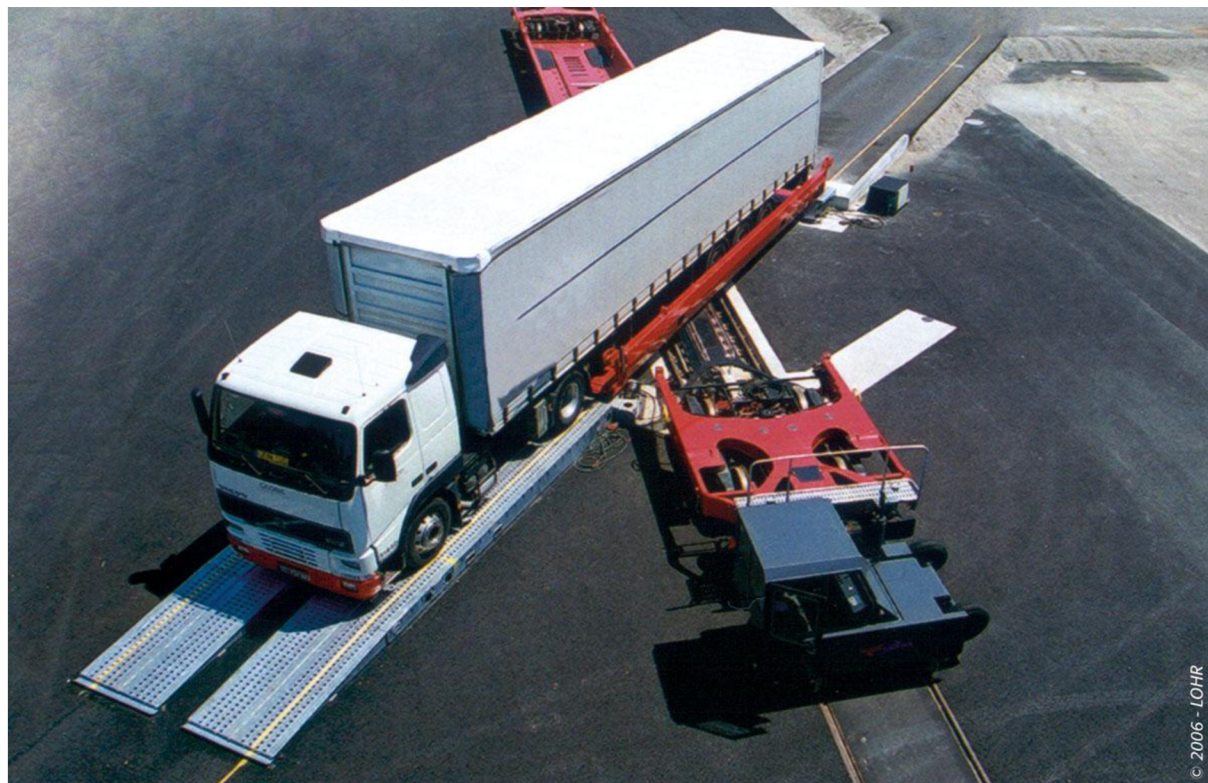
Obrázek 13 - Způsob překládky systémem Modalohr. [11]
