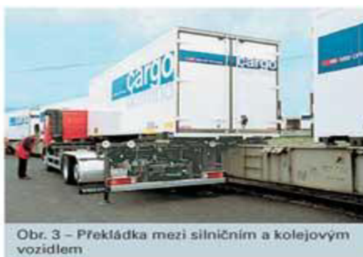
Obrázek 2 - Vizualizace systému překládky Mobiler. [30]
