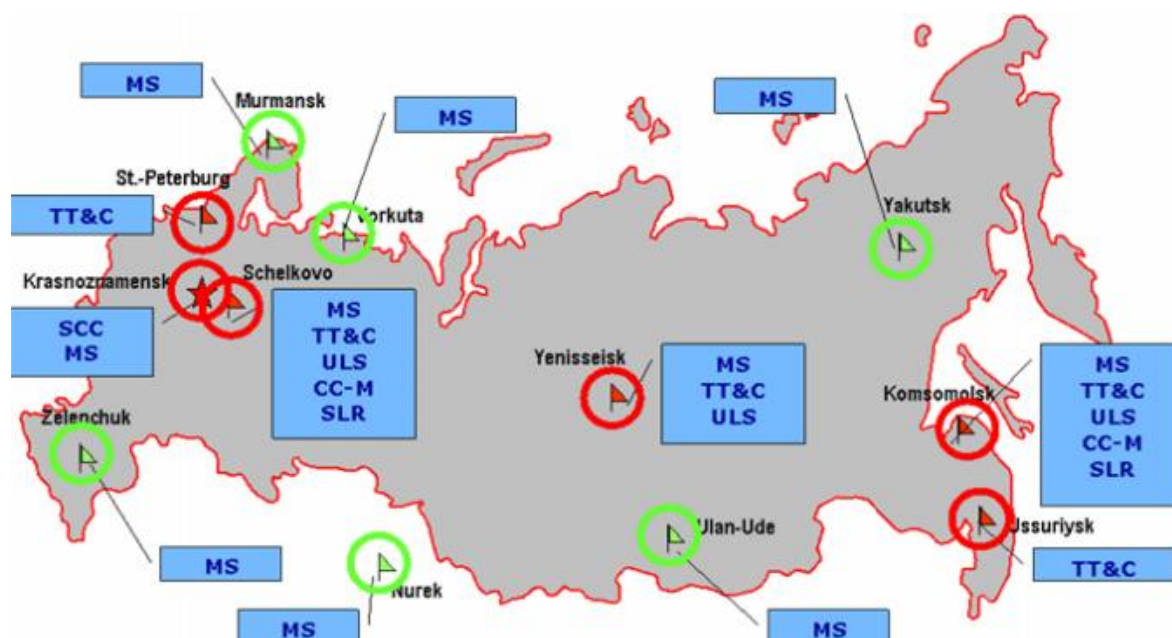
Obr. 3-11: Rozmístění kontrolního a řídicího segmentu systému GLONASS [14]
