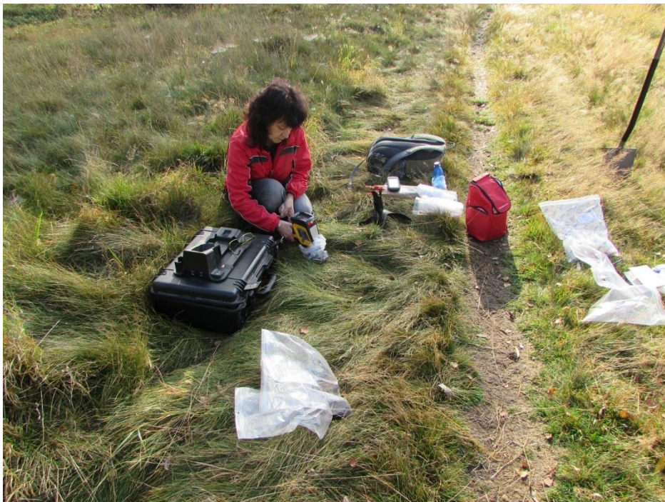
Měření odebraných vzorků mobilním analyzátoem XRF
