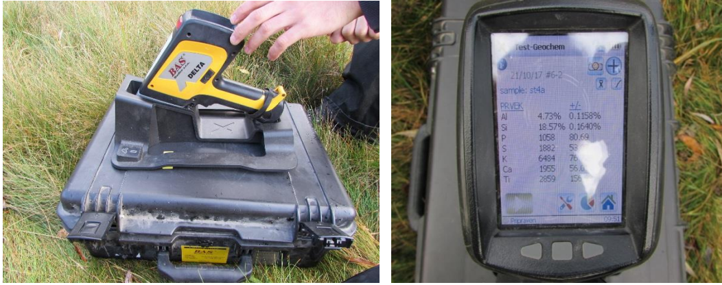
Obrázek č. 12 a 13 Rentgenový analyzátor prvků použitý k měření odebraných vzorků (foto Alena Štichová)
