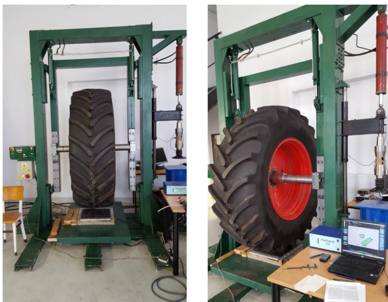
Obrázek č. 27. Laboratorní zařízení pro testování pneumatik s regulovatelným zatížením a plantografem (namontovaná pneumatika - Mitas 650/65R38 RD-03)
