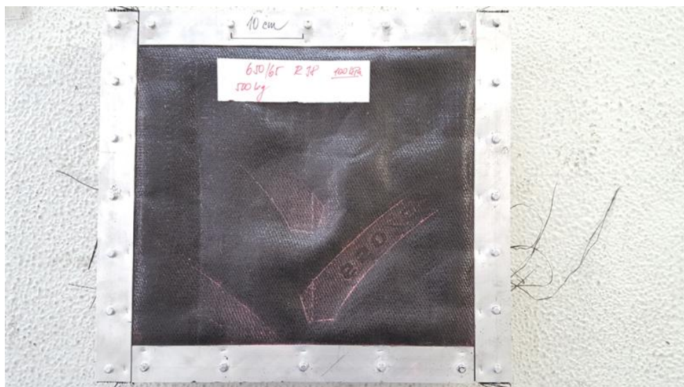
Příloha 1: Otisk šípů pneumatiky Mitas 650/65R38 při tlaku huštění 100 kPa
