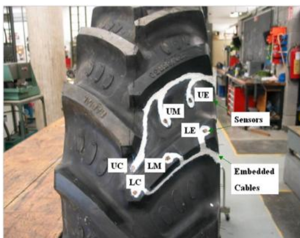
Obrázek č. 18. Instalace senzorů na radiální pneumatice 16.9R38
