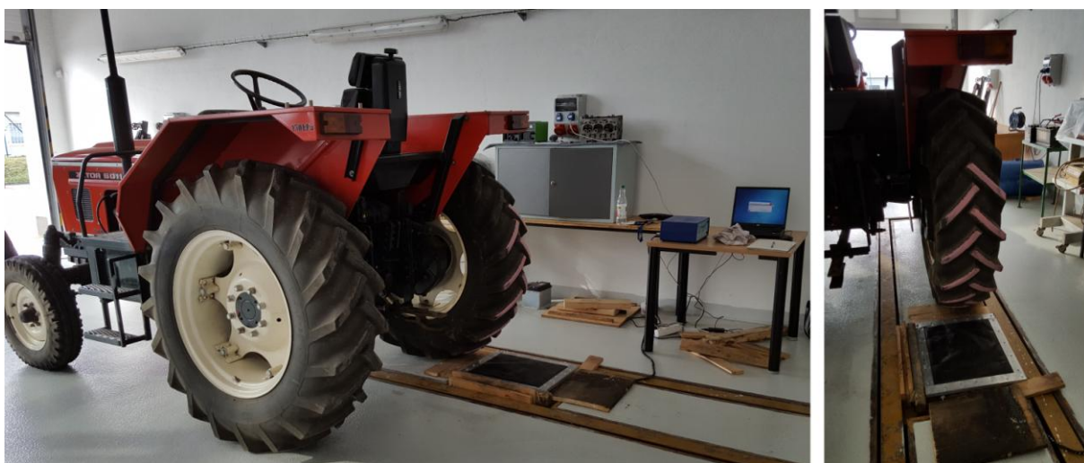
Obrázek č. 29. Porovnávání dynamického a statického zatížení pneumatiky Barum 14,9-28 pomocí plantografu
