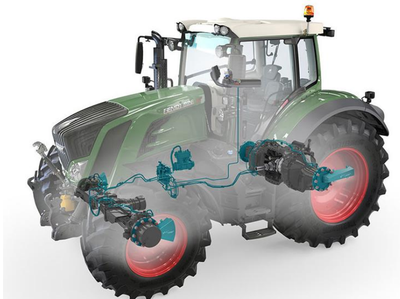
Obrázek č. 21. Integrovaný systém centrálního huštění pneumatik od firmy Fendt
