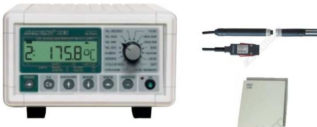
Obr. 34 Měřicí ústředna a čidla Ahlborn [23]
