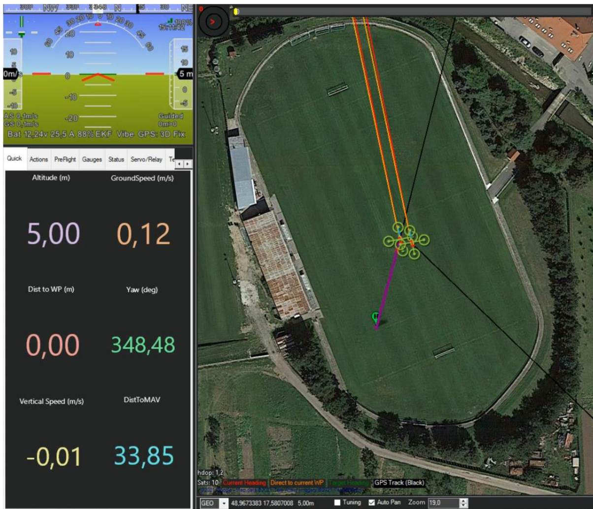
Obrázek 3.12 Simulace antikolizního systému
