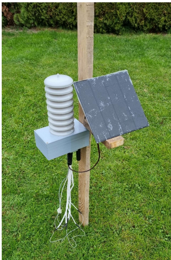
Obrázek 22: Kompletně sestavená meteorologická stanice
