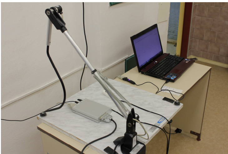
Obrázek 11. Základní deska se třemi nastavovacími body sloužící k upevnění polohového snímače a elektronická vyhodnocovací jednotka posílající údaj o poloze snímačů do počítače.
