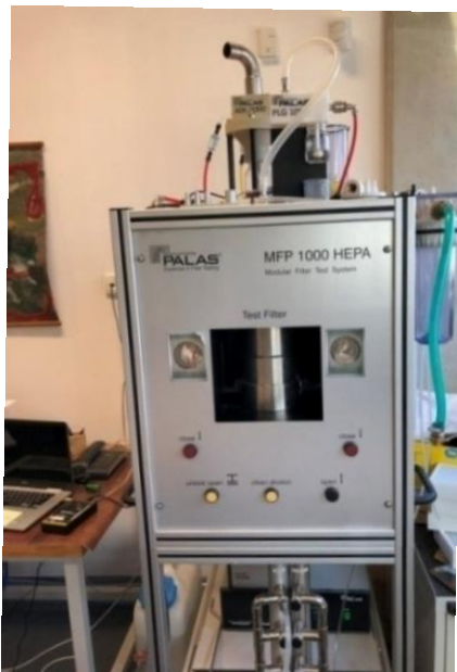
Obr. 26 a Obr. 27 Přístroj MFP 1000 HEPA a detail záobníku DEHS
