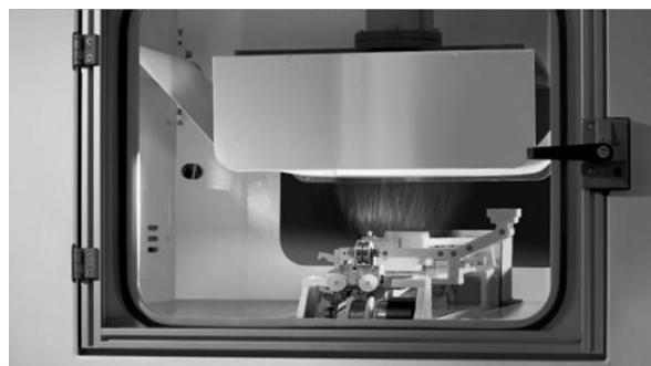
Obr. 4 Schéma stroje Nanospider [Jirsák et al., 2004] a Obr. 5 Dnešní podoba stroje Nanospider se zvlákňovací strunou [Elmarco, nedatováno a]
