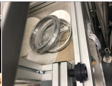
Obr. 28 a Obr. 29 Přístroj a detail držáku uchycení filtru.
