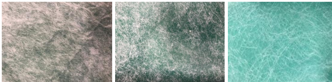
Obr. 18 a Obr. 19 a Obr. 20 Pohled na pavučiny pojiva. Zleva PP/PE, coPES, coPA.
