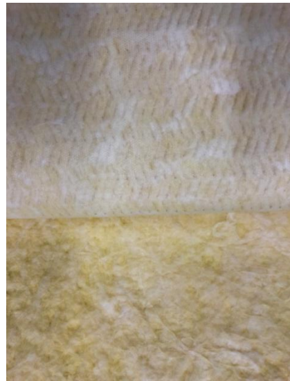
Obr. 14 a Obr. 15 Základní materiály. Ve spodní části je lícová strana, v horní části je rub. Nalevo je vpichovaný polypropylenový filtr, napravo je filtr ze skla s pokladovou textilií vyrobenou technologií spunbond.
