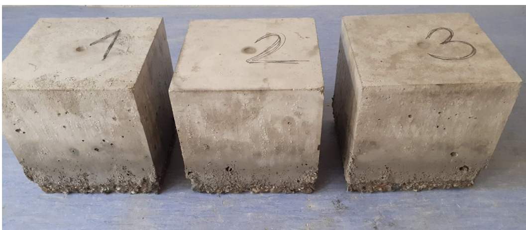
Obr. 2.12: Tělesa zkoušená na odolnost proti CHRL metodou A.
