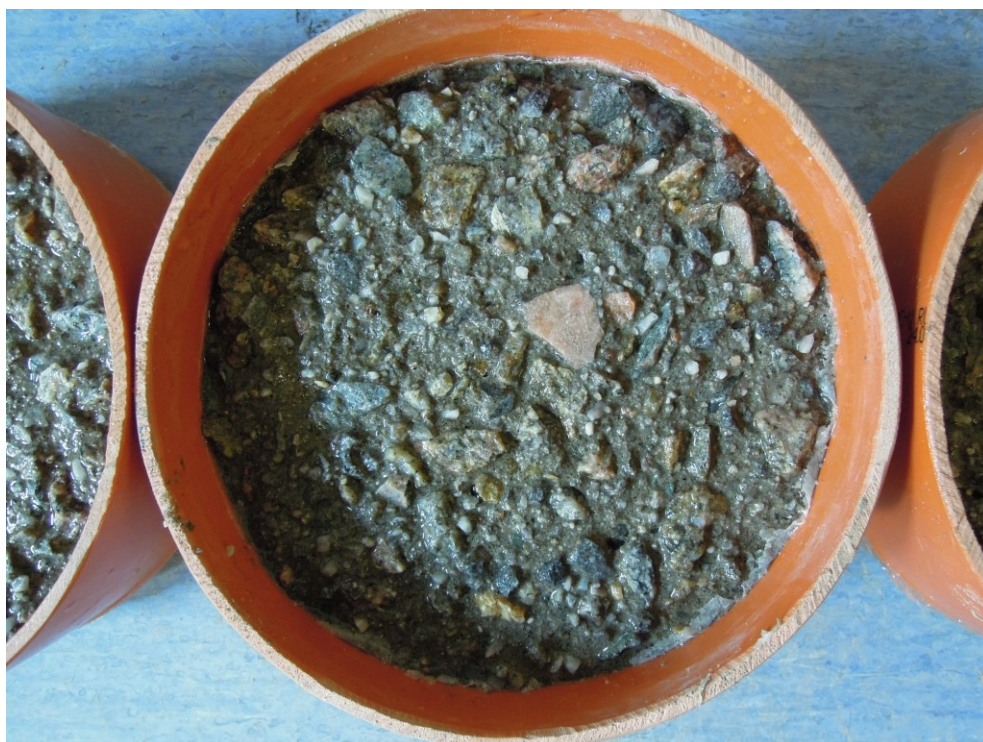
Obr. 2.15: Povrch tělesa poškozený CHRL při metodě C.
