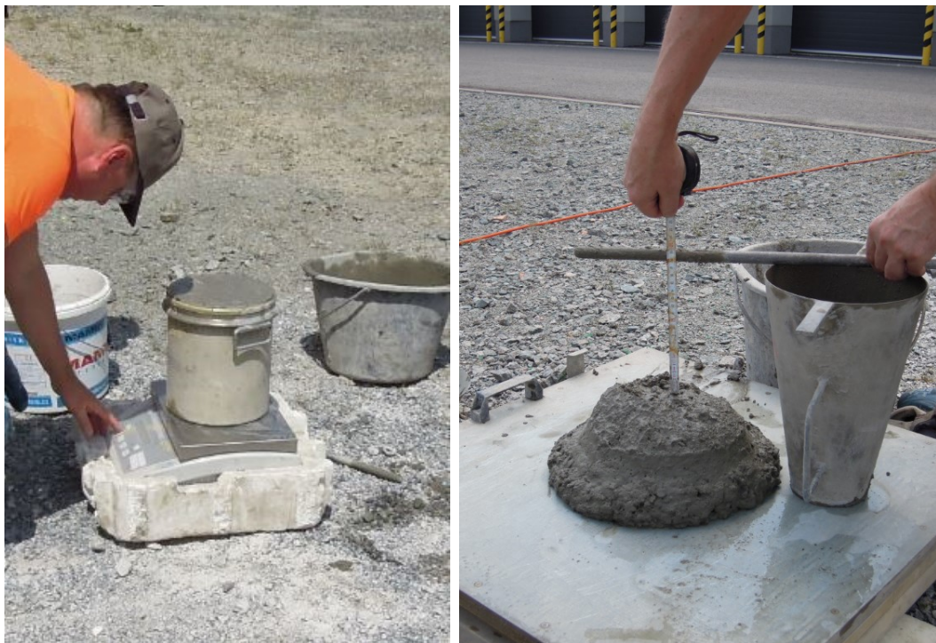
Obr. 2.2: Zkouška konzistence čerstvého betonu rozlitím.
