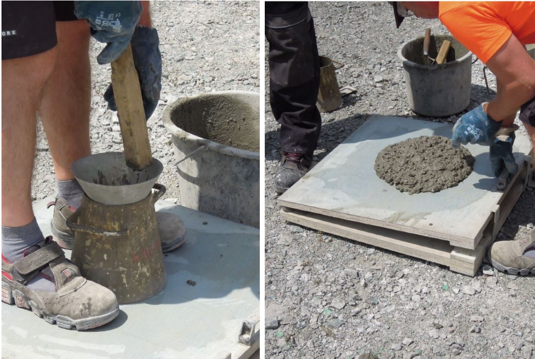
Obr. 2.2: Zkouška konzistence čerstvého betonu rozlitím.
