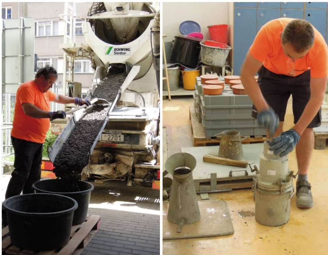
Obr. 2.6: Vykládka betonu na FAST a zkouška tlakovým hrncem.
