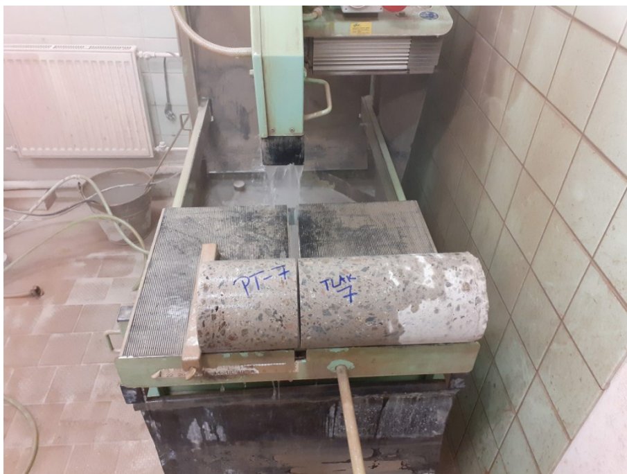
Obr. A.16: Dělení vývrtnu na dvě zkušební tělesa.
