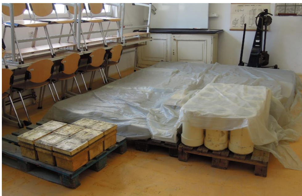
Obr. A.13: Uložení těles a ošetření proti ztrátám vlhkosti.
