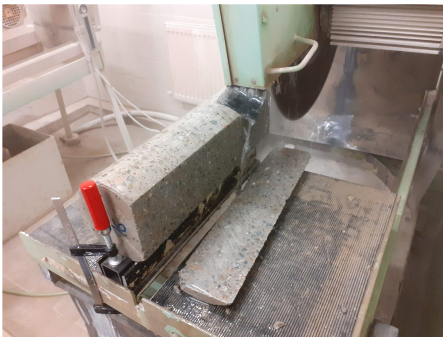
Obr. A.17: Úprava vývrtnu na těleso tvaru hranolu.
