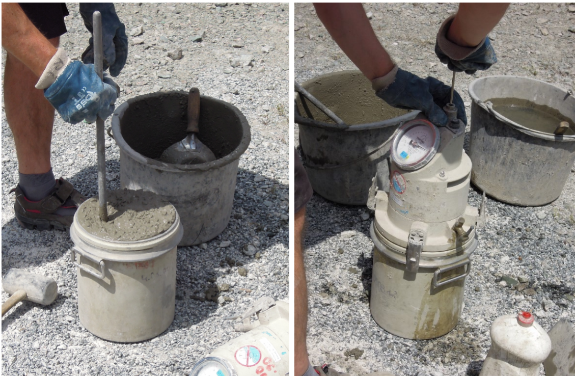
Obr. 2.1: Zkouška obsahu vzduchu tlakovým hrcem.
