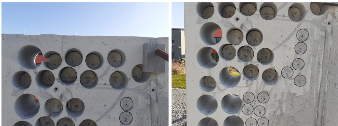
Obr. 2.17: Vývrty v bloku.
