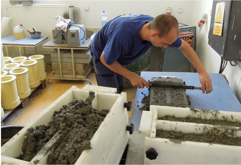
Obr. 2.7: Výroba zkušebních trámců.
