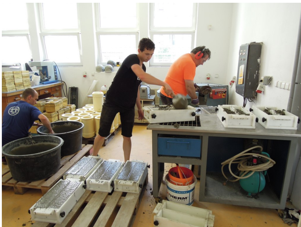
Obr. A.10: Plnění forem a výroba těles.
