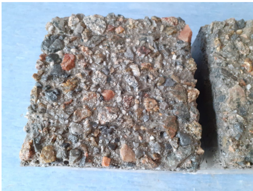
Obr. 2.14: Povrch tělesa poškozený CHRL při metodě A.
