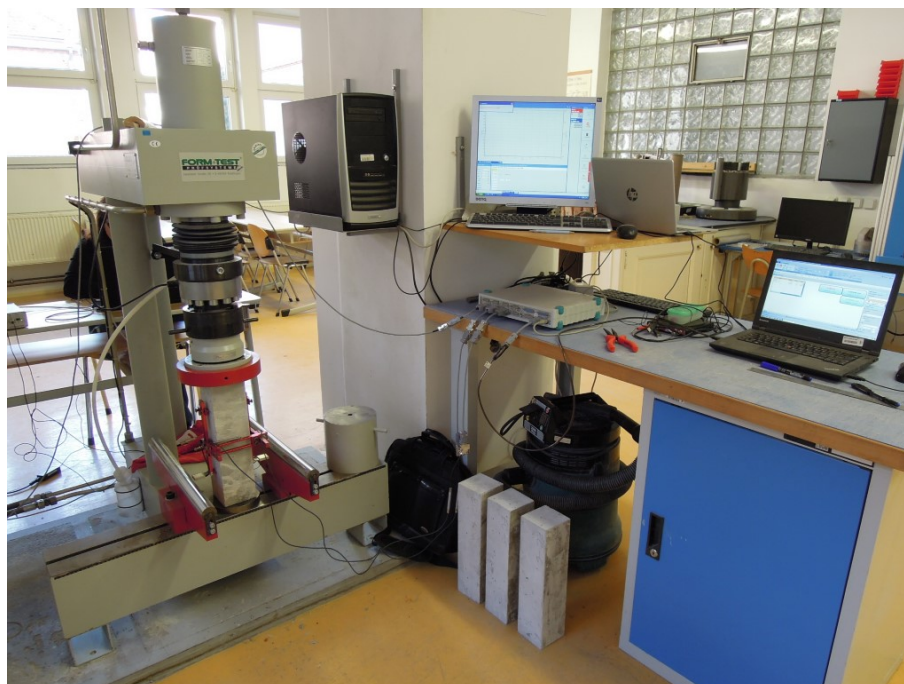
Obr. B.15: Vybavení pro zkoušku statického modulu pružnosti.
