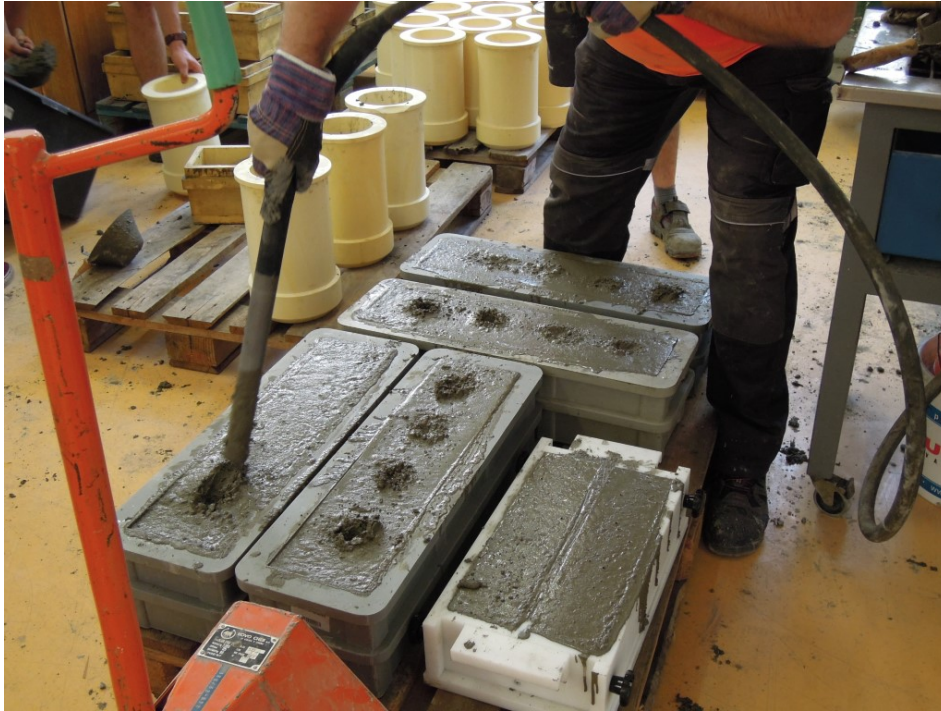
Obr. 2.9: Hutnění betonu ve velkých formách.
