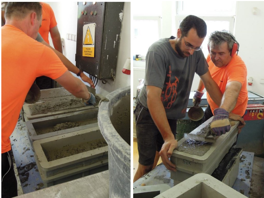
Obr. A.12: Hutnění betonu na vibračním stole.
