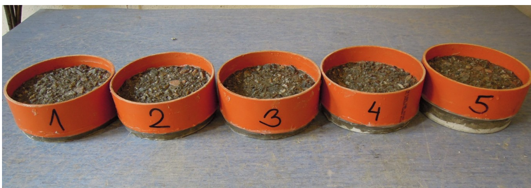
Obr. 2.13: Tělesa zkoušená na odolnost proti CHRL metodou C.
