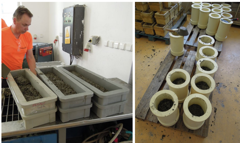
Obr. A.11: Výroba velkých hranolů a zkušebních válců.
