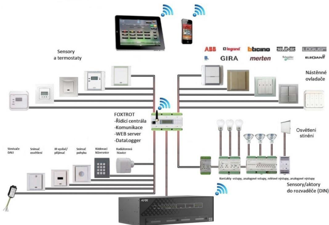
Obr. 2.1 Systémová elektroinštalácia s hviezdicovou topológiou spoločnosti Insight Home . Prevzaté z [1].
