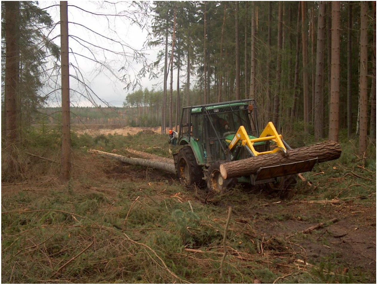
Obrázek 11: Přibližování dřevní hmoty
