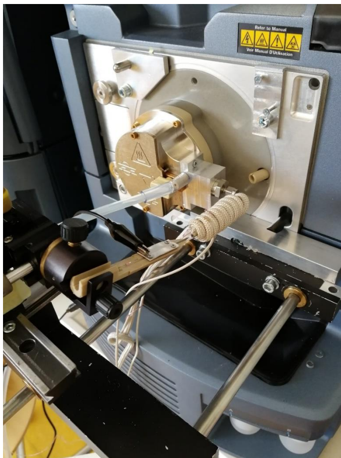
Obr. 28: Konstrukce nanoESI přístroje vytvořeného na Katedře analytické chemie PřF UP.
