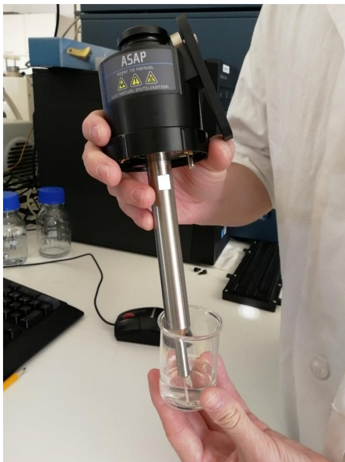
Obr. 27: Nanášení vzorku na skelněnou kapiláru ASAP sondy.
