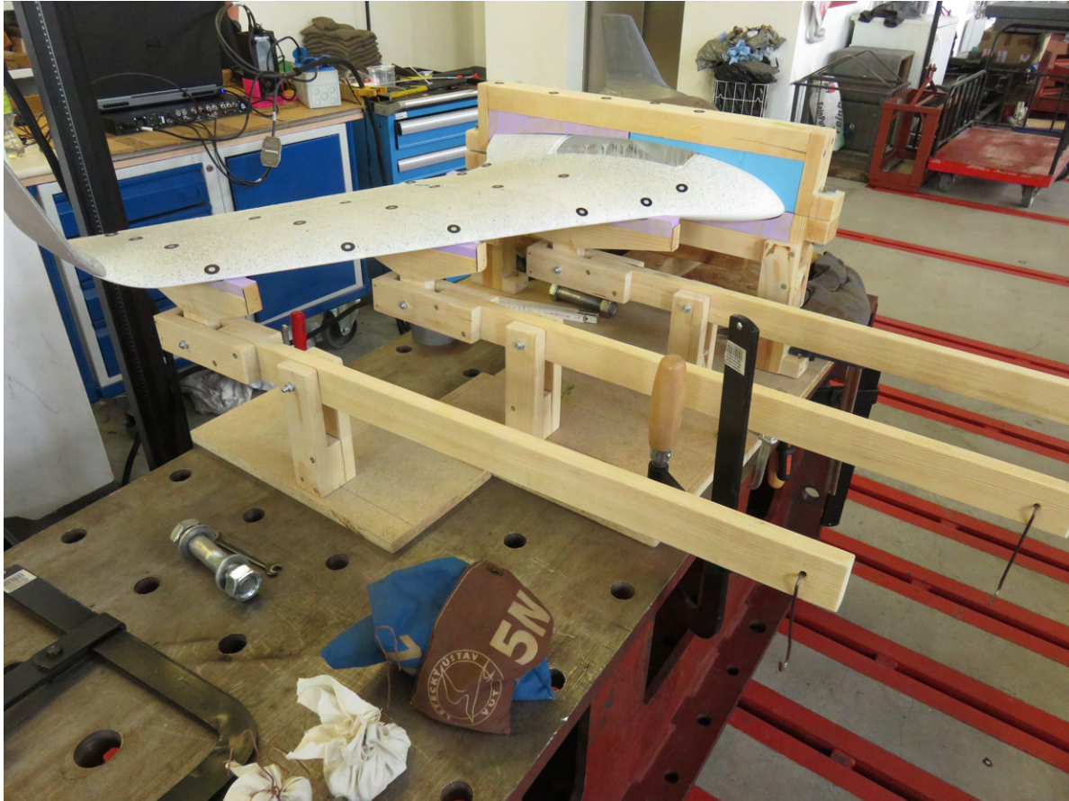
Obrázek 8.1: Zatěžovací systém využitý při statické pevnostní zkoušce.
