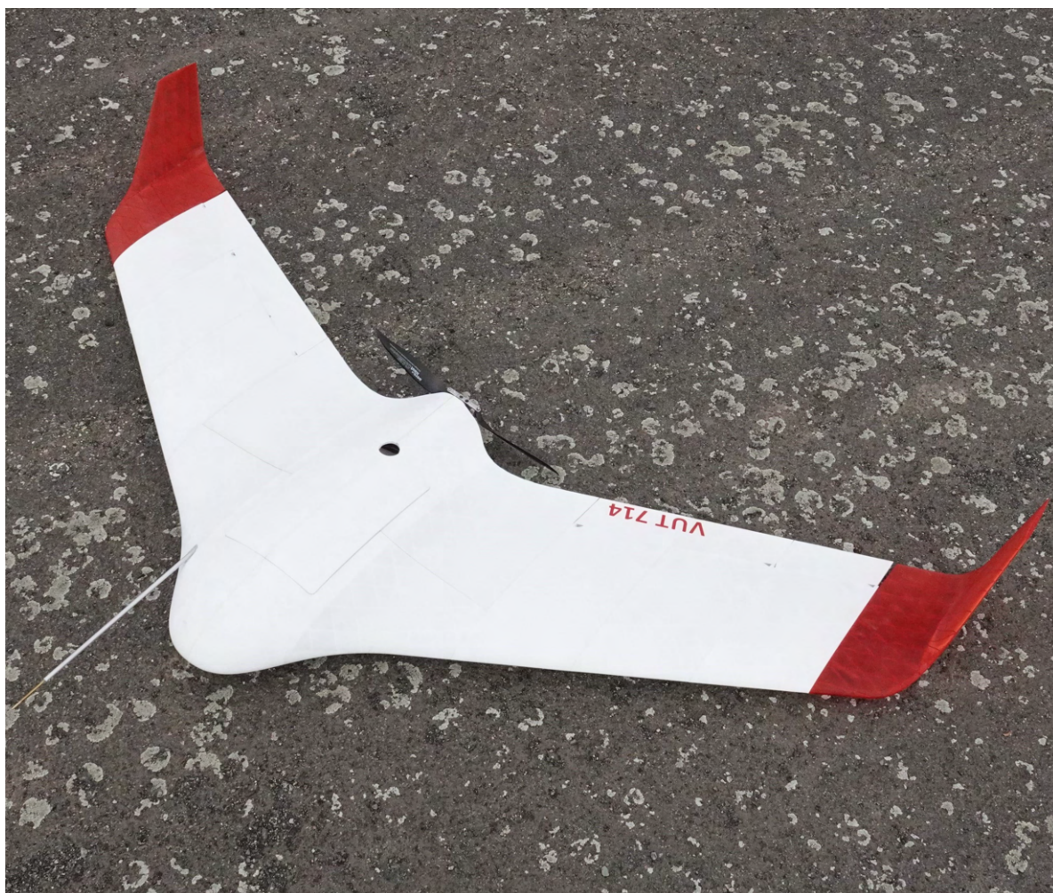
Obrázek 2.1: Prototyp 3D tištěného letounu VUT 714.
