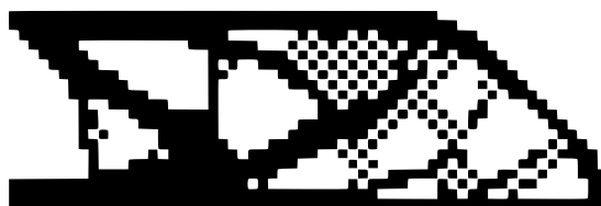
Obrázek 12.14: Demonstrace nežádoucího šachovnicového efektu [11].
