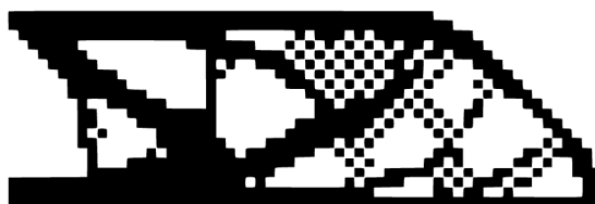
Obrázek 12.14: Demonstrace nežádoucího šachovnicového efektu [11].
