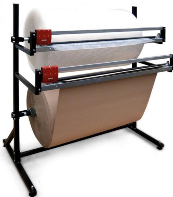
Obr. 59: Řezací stojan pro papír i fólii [30]
