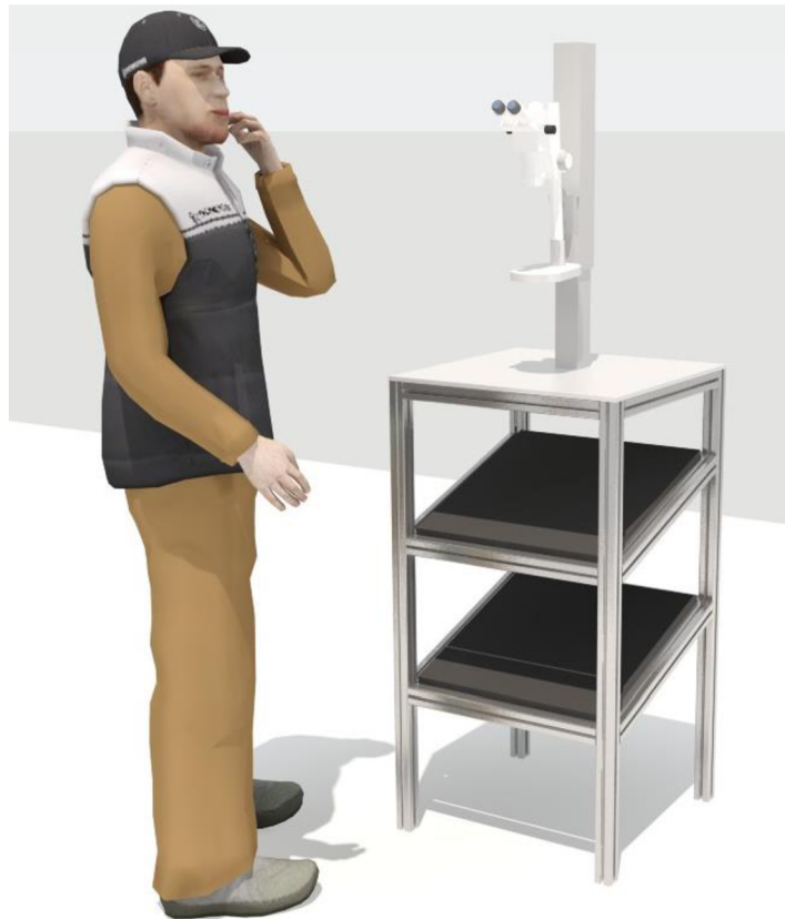
Obr. 67: Ergonomický stůl pro kontrolu kvality [interní foto firmy]
