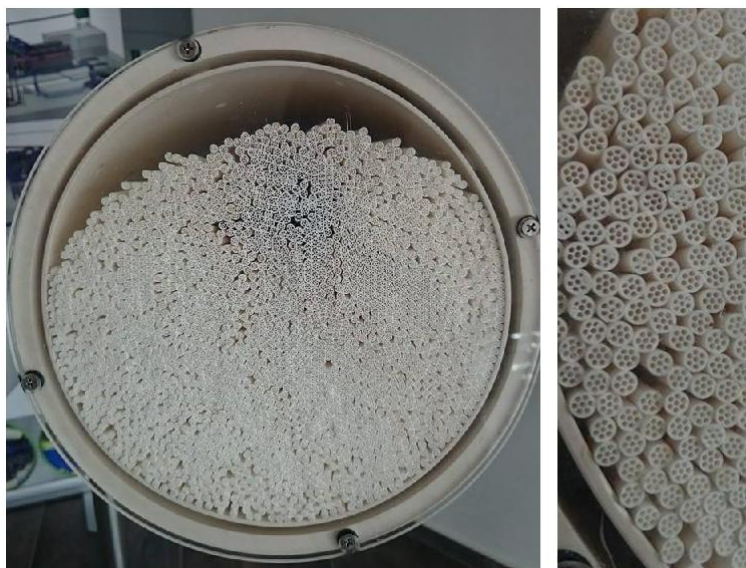
Obr. 4.13 Řez membránovým modulem a jeho detail
