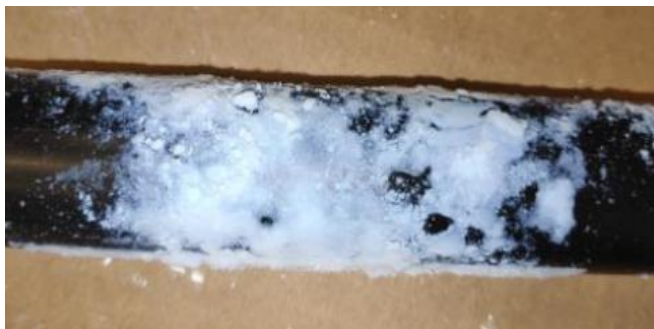
Obr. 18 PA váleček po rozetření bílých sazí [18]
