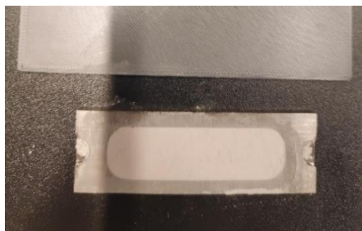
Obr. 19 Bílé saze po rozetření plastovou deskou [18]
