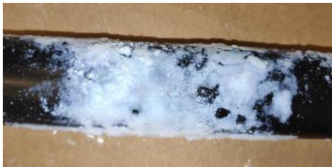
Obr. 18 PA váleček po rozetření bílých sazí [18]
