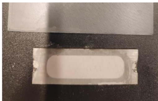
Obr. 19 Bílé saze po rozetření plastovou deskou [18]
