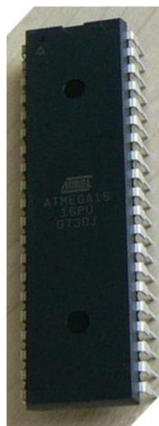
Obr. 2.2: Označení pinů [5] a pouzdro (DIP40) ATmega16
